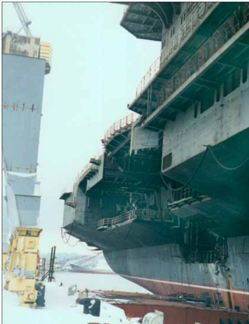
Prawoburtowy rufowy podnośnik lotniczy w położeniu górnym – pokładowym. Zima 1997 r. Fot. W. I. Katajew
