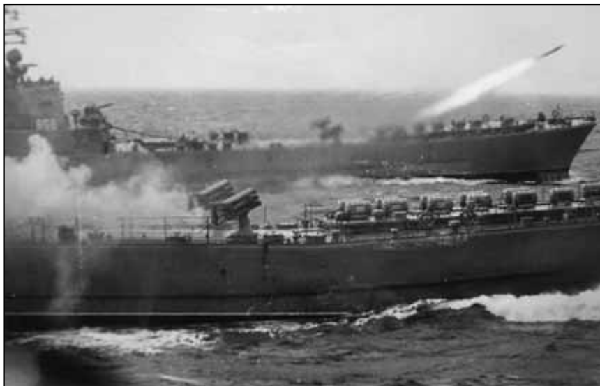
Ostrzał wybrzeża z wyrzutni Niekierowanych Pocisków Rakietowych WM-18. Każdy z okrętów projektów 770, 771, 773 i 776 oraz ich wariantów uzbrojony był w dwie wyrzutnie kalibru 140 mm. Fot. zbiory Waldemar Wierzykowski
