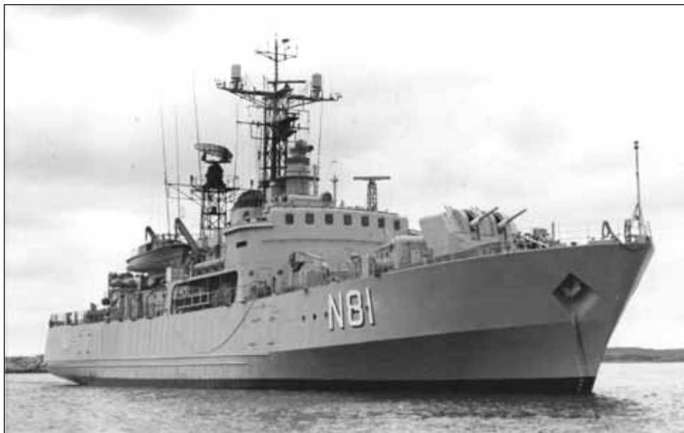
Duński stawiacz min Fyen typu „Falster”. Marynarka duńska posiadała cztery jednostki tego typu, każda zabierała po 400 min. Fot. zbiory Leo van Ginderen
