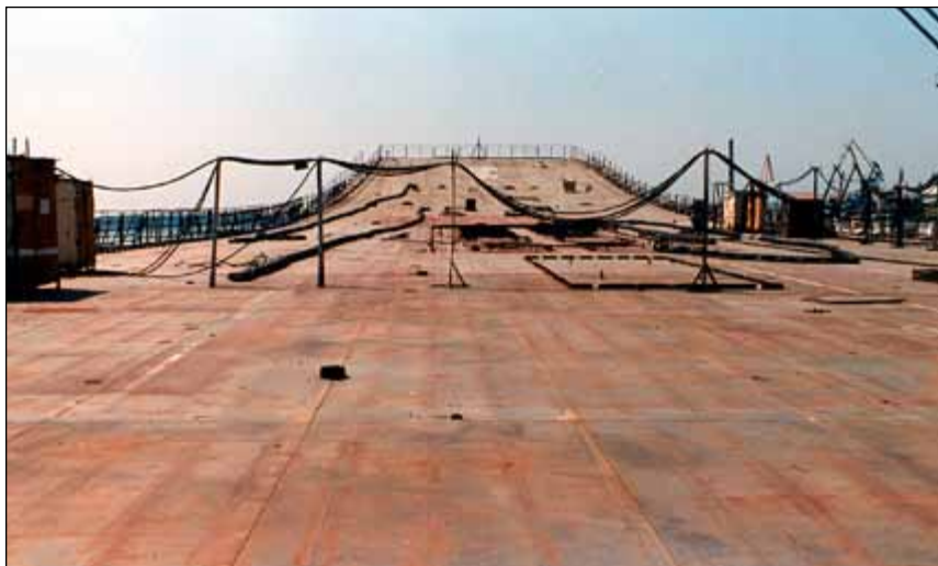
Widok pokładu lotniczego w kierunku dziobowej rampy startowej. Widoczne w nim silosy rakiet przeciwokrętowych „Granit”. Fot. Anatolij N. Odajnik
