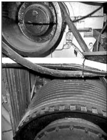
Cichy napęd typu XXI: wieloklinowa przekładnia pasowa. U góry koło pasowe na wale silnika, na dole koło pasowe na wale śrubowym. Fot. Mieczysław Jastrzębski
