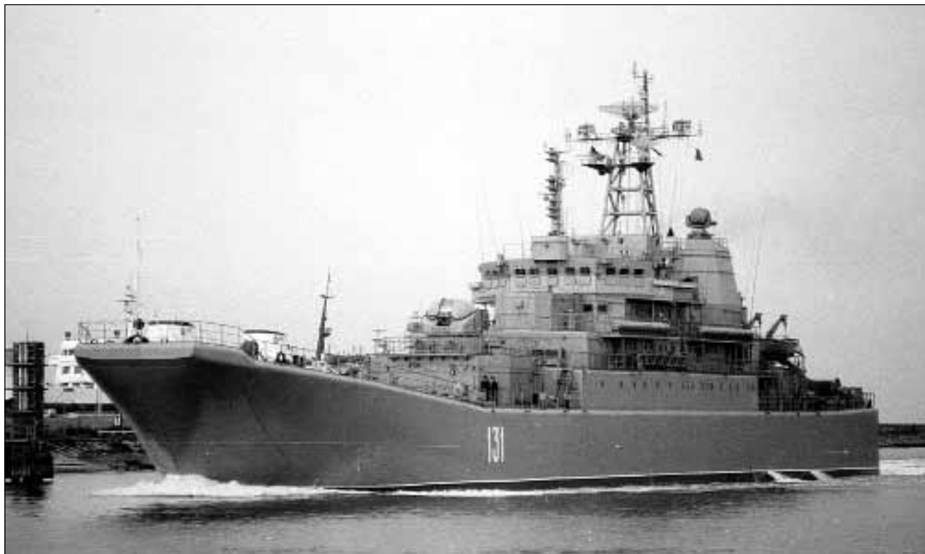
Duży Okręt Desantowy projektu 775. Okręty te klasyfikowano początkowo jako średnie. Ogółem w gdańskiej Stoczni Północnej w latach 1974-1991 zbudowano 28 okrętów w trzech wersjach, z czego ZSRR otrzymał 26. Flota Bałtycka ZSRR dysponowała 8 okrętami tego typu. Fot. Reinhard Kramer
