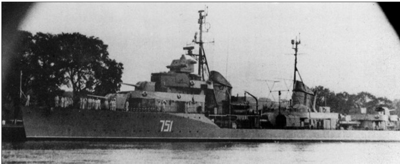
Nieidentyfikowany niszczyciel projektu 7U w Świnoujściu, połowa lat 50-tych. Widoczny charakterystyczny radar P-8 zamontowany na śródokręciu.
