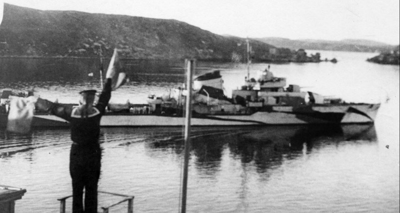
Griemiaszczij po demontażu osłon nad działami artylerii głównej Nr 1 i Nr 4 i przebudowie tarcz ochronnych na typ stosowany na czarnomorskich niszczycielach, około 1943-1944 roku. Fot. zbiory A. Kuzenkowa
