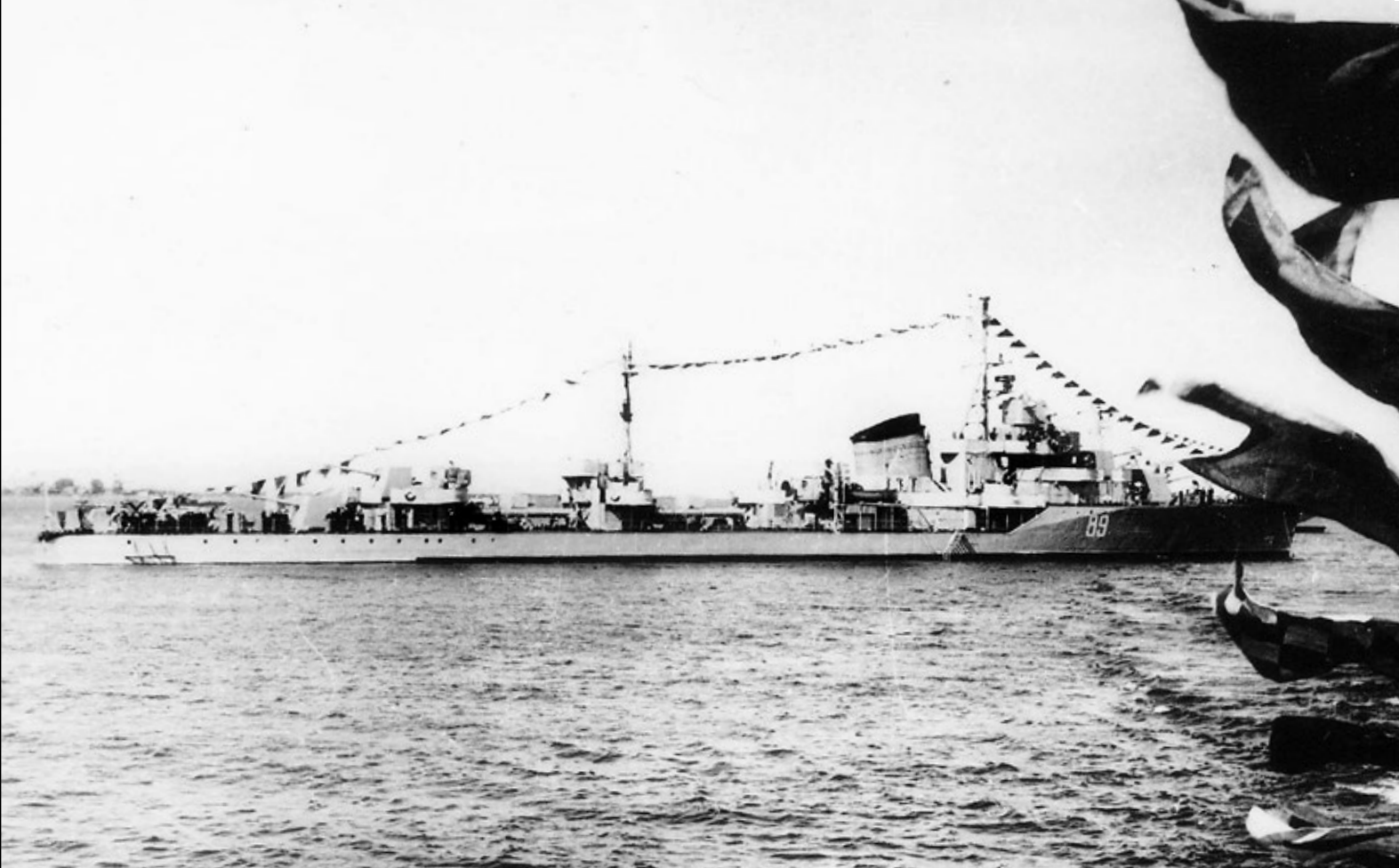
Niszczyciele projektu 7, które przeszły remont kapitalny i modernizację na bazie typowego projektu modernizacji CKB-53: Griemiaszczij , (fot. górna) i Bojkij (fot. dolna). Na tych jednostkach zachowano pojedyncze maszty przednie, a na Griemiaszczij – nawet działa B-13 I serii z prostokątnymi tarczami ochronnymi. Artyleria przeciwlotnicza została jednak na wszystkich niszczycielach wymieniona na 4 podwójnie sprzężone działa kal. 37 mm B-11. Fot. zbiory Władimira Zabłockiego
