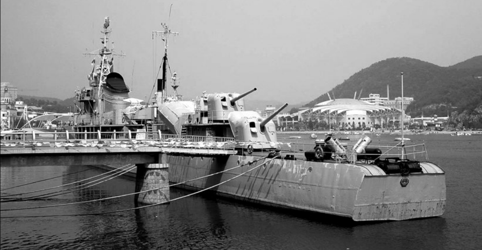
Niszczyciel Taiyuan (dawny Rietiviy ) w roli hulku szkolnego na przedmieściu Dalian. Bulaje w rejonie przedziałów maszynowo-kotłowych pojawiły się po demontażu głównych mechanizmów okrętu. Fot. Internet
