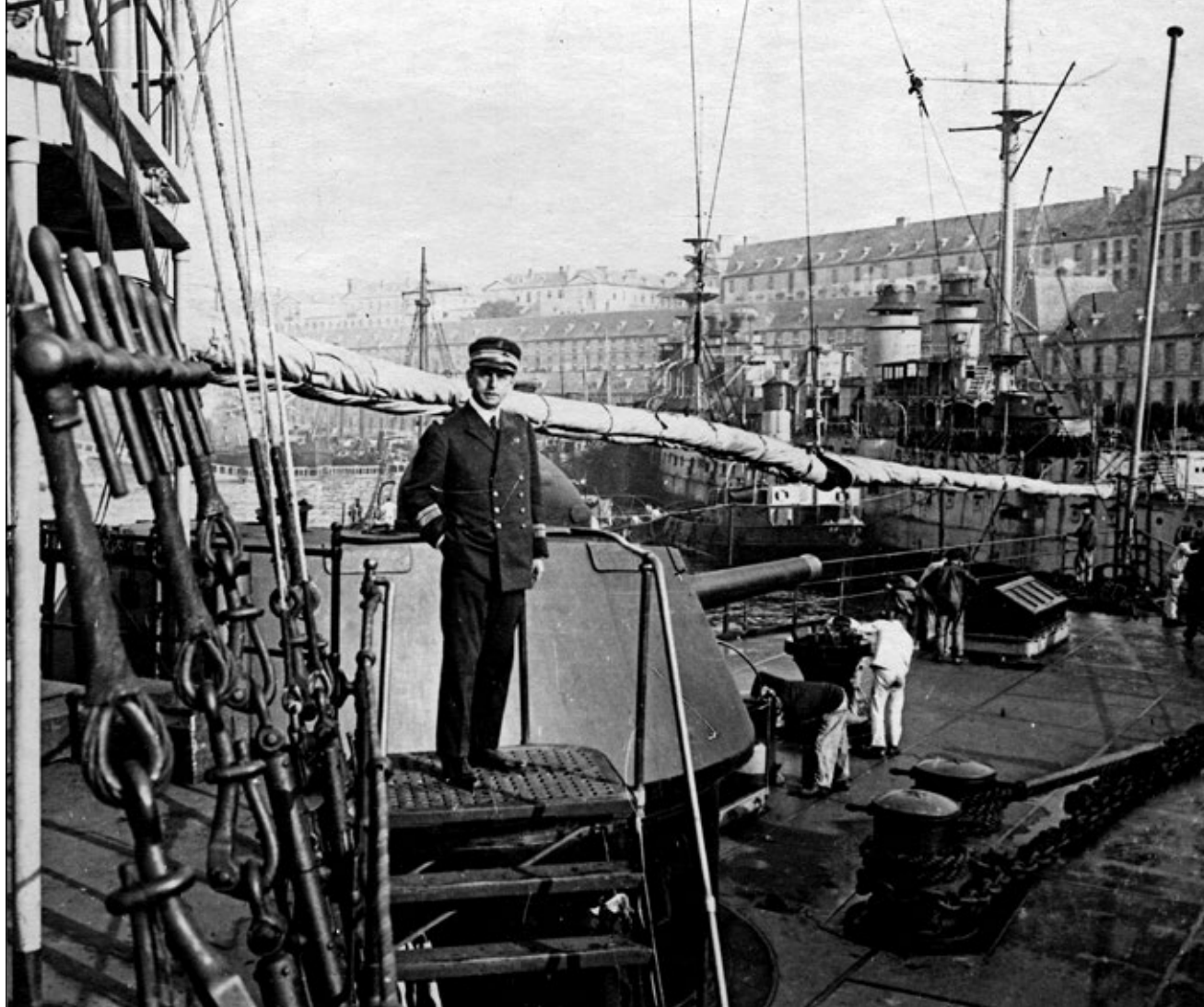
Rufowy pokład Jeanne d'Arc podczas pobytu okrętu w Breście. Na fotografii można zauważyć wieżę wraz z działem kal. 194 mm, zaś na drugim planie widoczny krążownik pancerny typu „Montcalm”.
