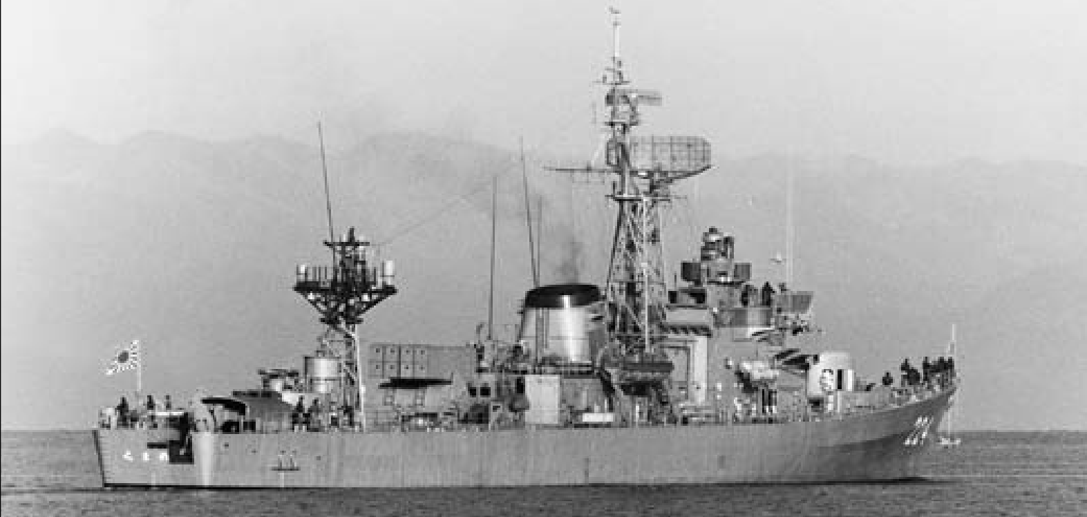
Ciekawe ujęcie bliźniaczego Kumano z 1989 roku. Dobrze widoczny rufowy sonar holowany oraz wyrzutnia ASROC.
