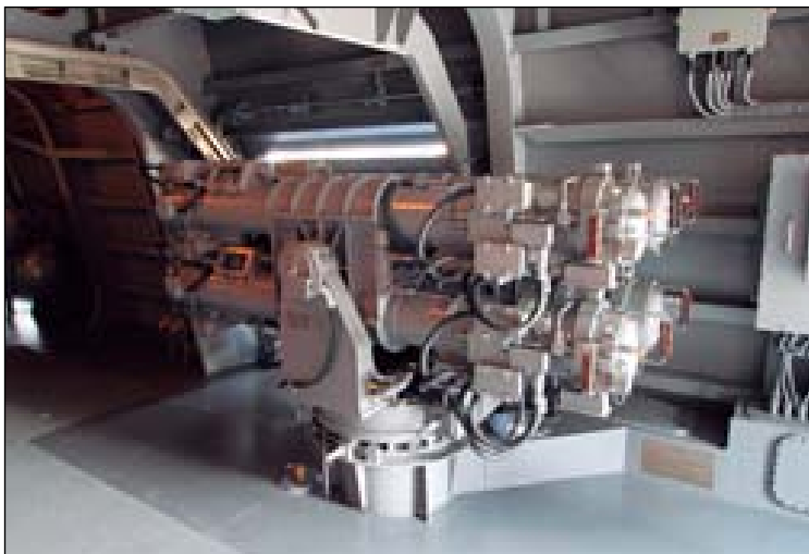
Wieżowa wyrzutnia pływających akustycznych celów pozornych typu FAJ. Fot. „Ships of the World”
