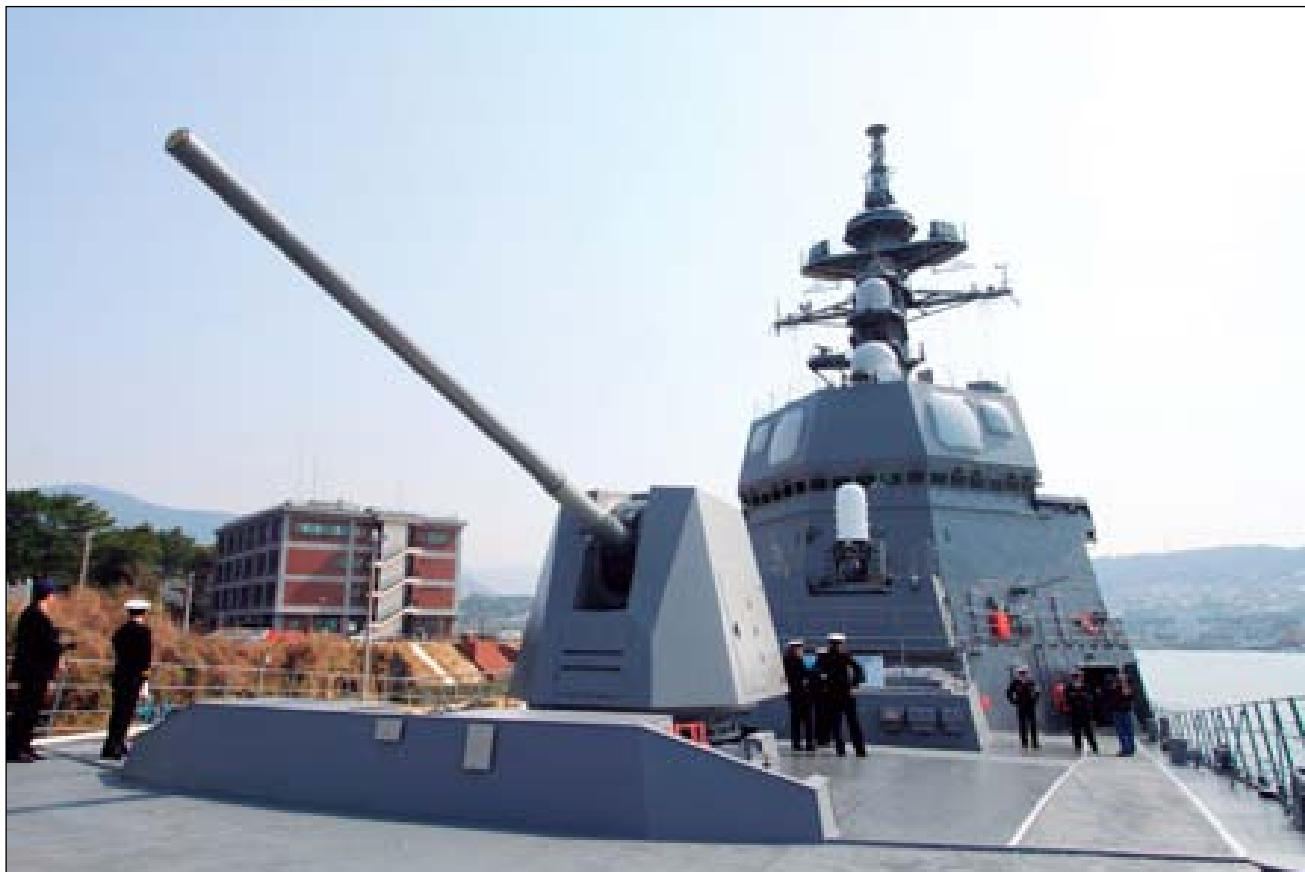
Tym razem ujęcie z dziobu w kierunku pomostu Akizuki . Uwagę zwraca długość lufy działa Mk 45 oraz płaskie anteny radarów FCS-3A na ścianach pomostu. Fot. „Ships of the World”
