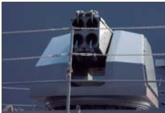
Wieżowa wyrzutnia pływających akustycznych celów pozornych typu FAJ. Fot. „Ships of the World”
