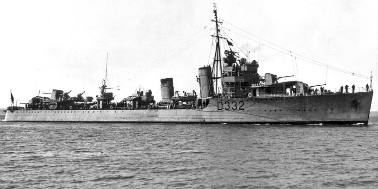
Niszczyciel Douro na fotografii z czerwca 1952 roku. Dobrze widoczne rozmieszczenie uzbrojenia po modernizacji.
