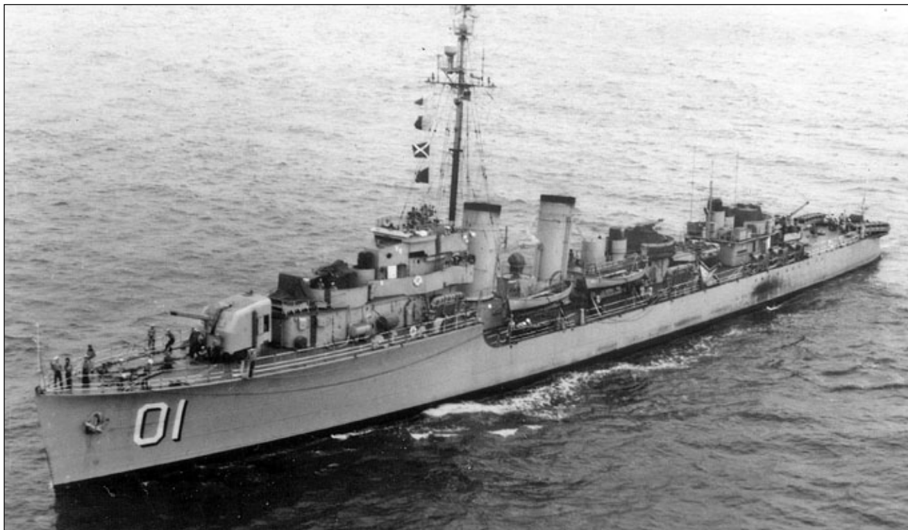
Antioquia po modernizacji w 1955 roku. Uwagę zwraca nowe amerykańskie uzbrojenie i elektronika.
