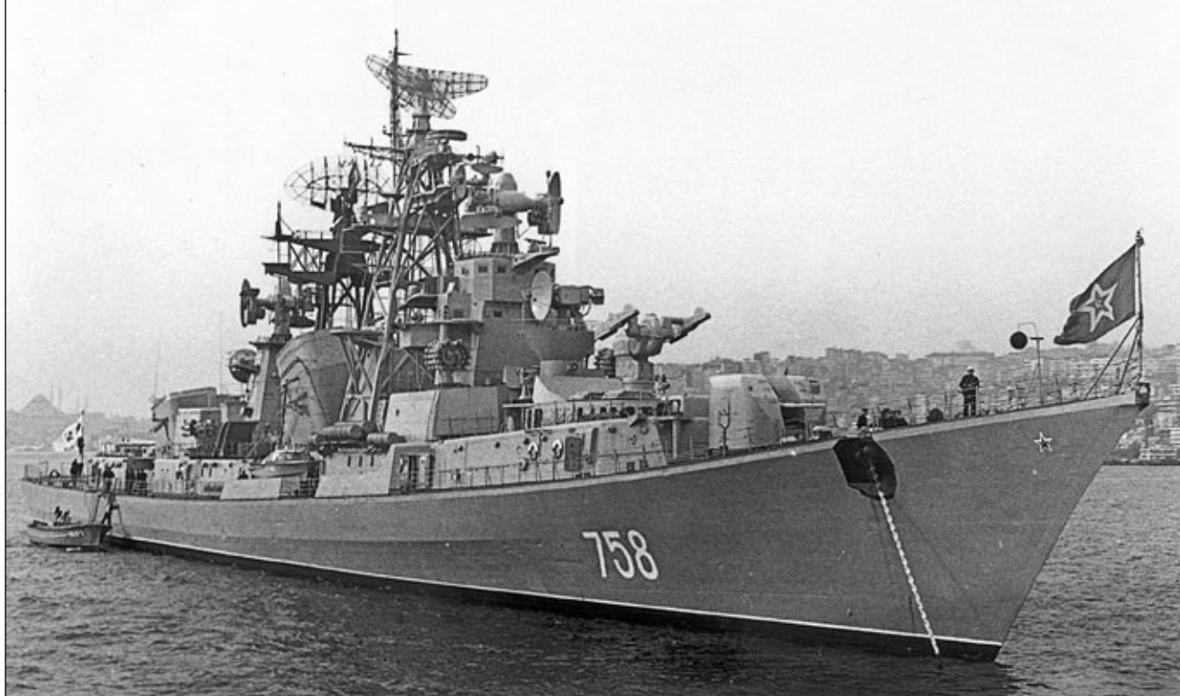
Radzieckie niszczyciele rakietowe proj. 61 (wg NATO typ „Kashin”) były pierwszymi na których do napędu zastosowano turbiny gazowe. Tutaj Reszitielnyj w czasie kurtuazyjnej wizyty w Istanbule, 10 października 1978 r. Fot. Hartmut Ehlers
