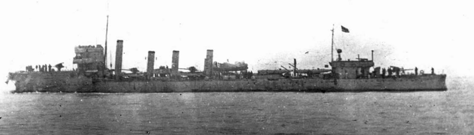
Lightfoot po kolizji z niszczycielem Oberon , która miała miejsce w marcu 1917 r. Dobrze widoczne uszkodzenia dziobu będące wynikiem zderzenia.
