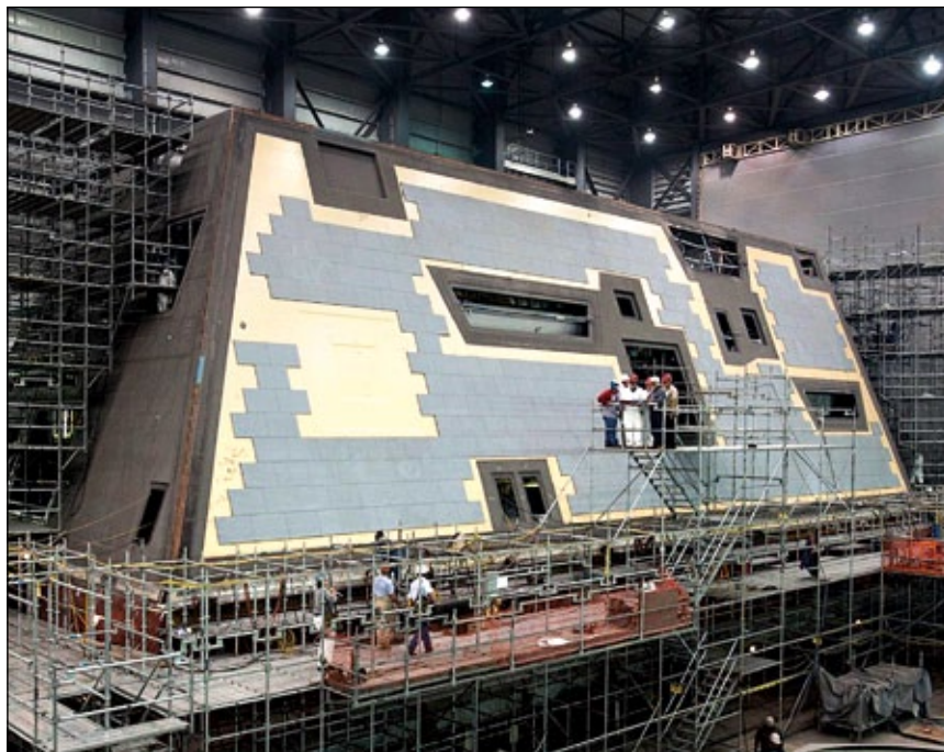
Nadbudowa niszczyciela Zumwalt podczas montażu w hali Huntington Ingalls Industries w Pascagoula. Fotografia wykonana w dniu 8 grudnia 2011 roku. Fot. U.S. Navy
