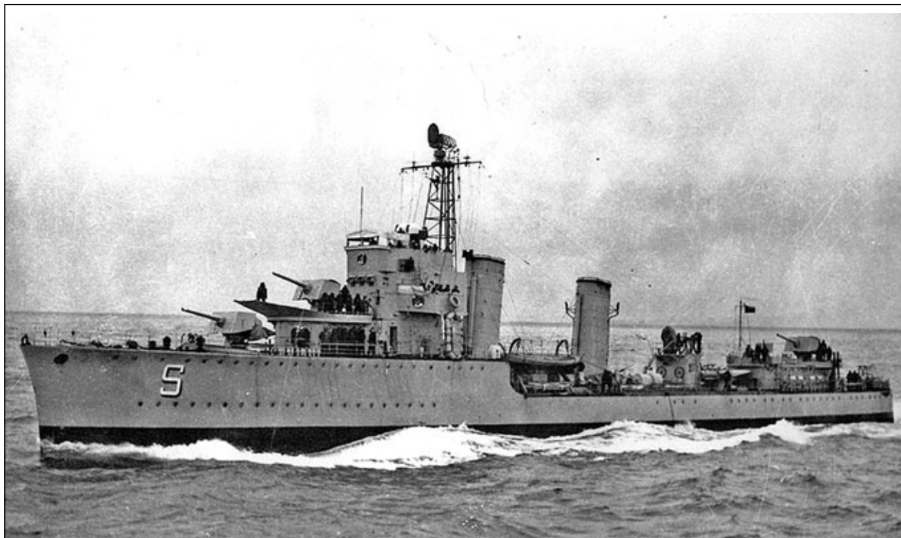
Niszczyciel Serrano po modernizacji z lat 50. XX wieku. Uwagę zwraca nowy maszt z radarem SG na jego szczycie.
