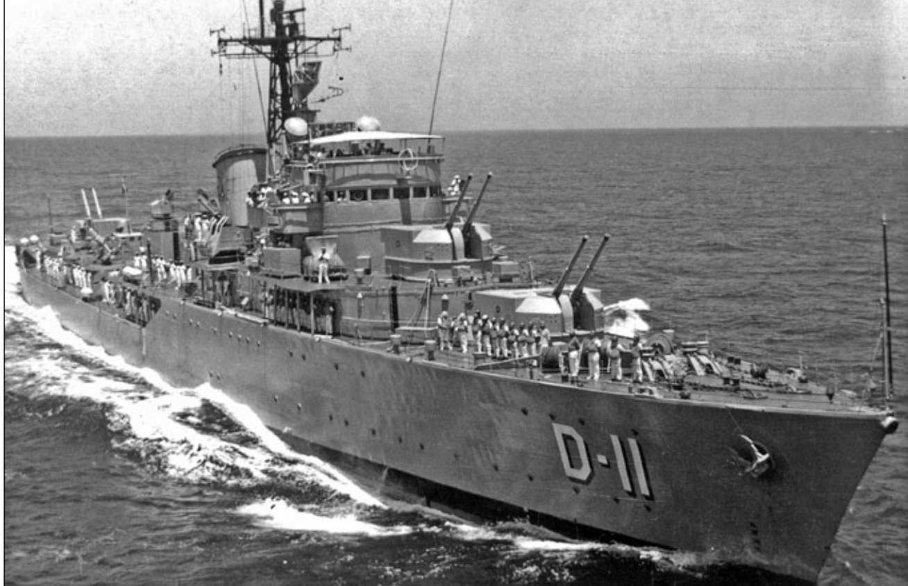
Nueva Esparta w czasie manewrów „UNITAS XI” we wrześniu 1970 roku. Na wysokości rufowego działka widoczna wyrzutnia rakiet przeciwlotniczych „Seacat”, które niszczyciel otrzymał po modernizacji w latach 1968-1969. Fot. U.S. Navy via „Warship International”
