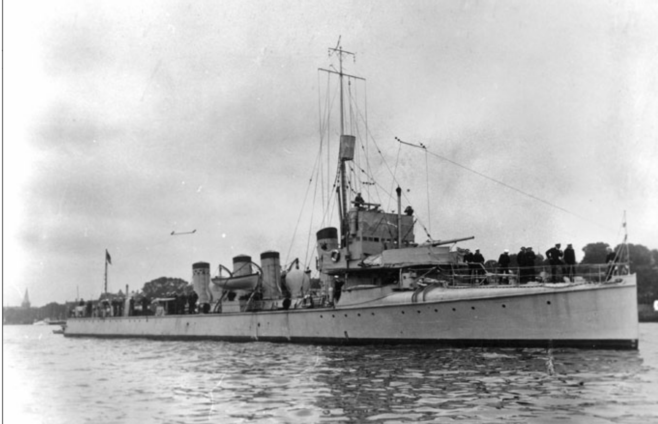
Vidar podczas wizyty w Kilonii w 1925 roku. Ma zabudowany i podwyższony pomost oraz antenę radiową.
