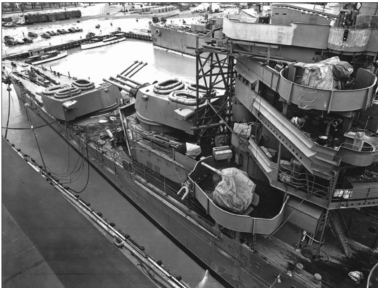
Widok na dziobową część krążownika New Orleans podczas remontu w Mare Island Navy Yard w Vallejo w styczniu-lutym 1942 roku. Wtedy to okręt został uzbrojony w cztery poczwórne stanowiska przeciwlotniczych działek kalibru 28 mm na skrzydłach pomostu obserwacyjnego oraz na pokładzie rufowym.
