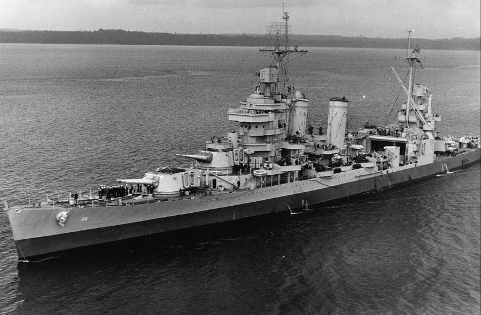
Minneapolis na fotografii wykonanej w dniu 27 czerwca 1945 roku po ostatniej wojennej modernizacji przeprowadzonej w Puget Sound Navy Yard w Bremerton. Okręt jako jedyny z krążowników typu New Orleans , dla wzmocnienia obrony przeciwlotniczej sektorów dziobowych otrzymał podwójne stanowisko dział kalibru 40 mm na wieży artylerii głównej Nr 2.
