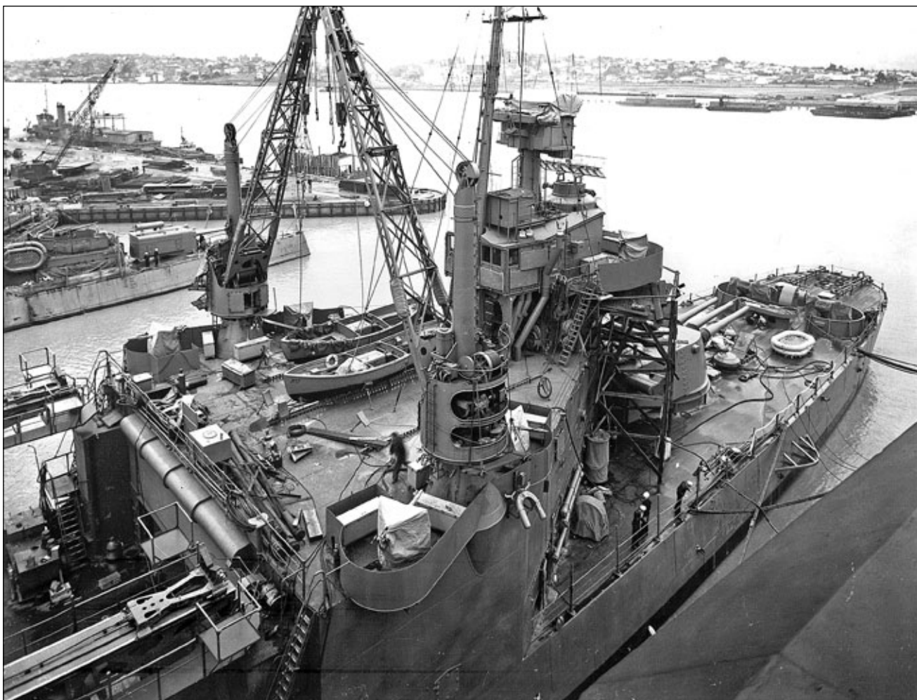
Podczas remontu w stoczni marynarki w Vallejo w styczniu-lutym 1942 roku New Orleans otrzymał przeciwlotnicze działka kalibru 20 mm Oerlikon (widoczne pojedyncze ich stanowiska na dachu hangaru) oraz radary Mk 3 (FC) wspomagające dalecełowniki artylerii głównej Mk 31, których anteny usytuowano na ich dachach.
