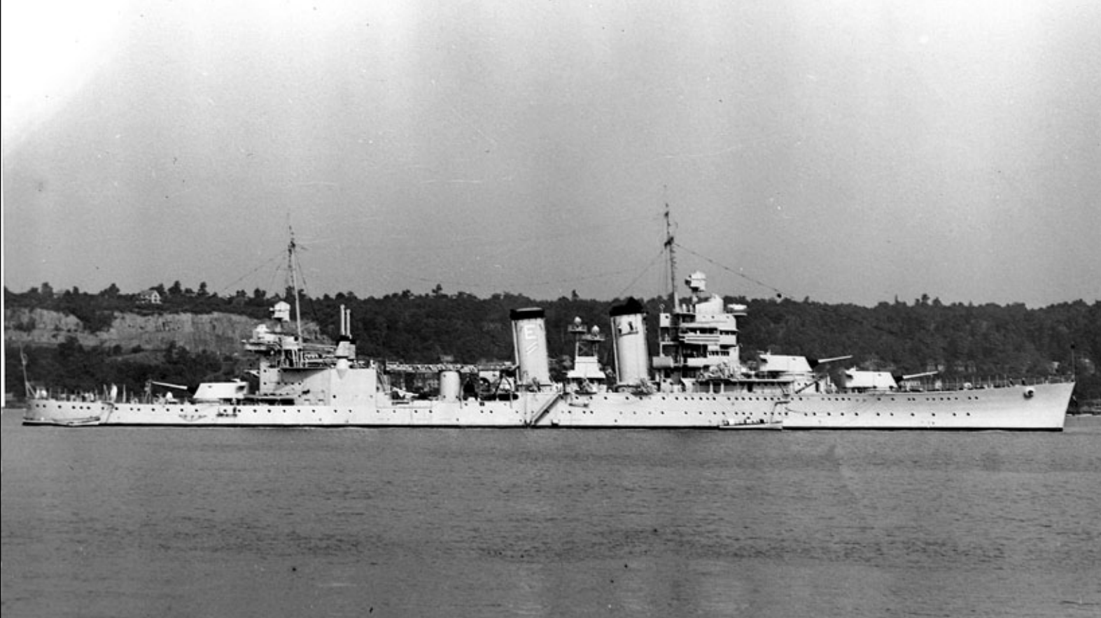
Krażowniki typu New Orleans otrzymały dwa kompleksy nadbudówek, z których przedni zawierał pomosty dowodzenia i kierowania okrętem, a także pomieszczenia najwyższych rangą oficerów. Nadbudówka rufowa stanowiła kompleks z hangarem pokładowych wodnosamolotów rozpoznawczych. Tutaj Tuscaloosa w dniu 21 lipca 1939 roku. Fot. zbiory Leo van Ginderen
