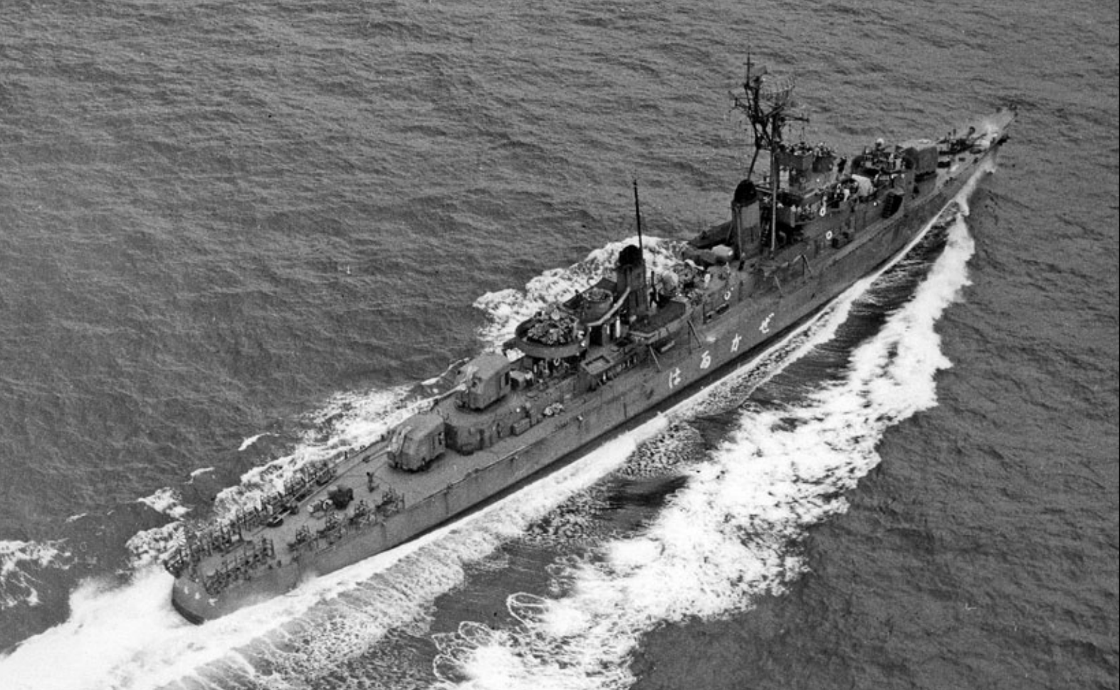
Harukaze na próbach morskich w ciekawym ujęciu. Był to pierwszy zaprojektowany i zbudowany okręt tej klasy w Japonii po wojnie. Na rufie zrzutnie i miotacze bomb głębinowych. Fot. „Ships of the World”
