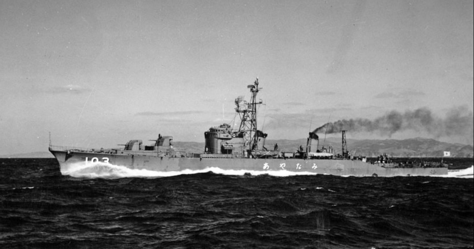
Ayanami w czasie ostatnich prób morskich, widoczny charakterystyczny dla tego typu uskok kadłuba.
