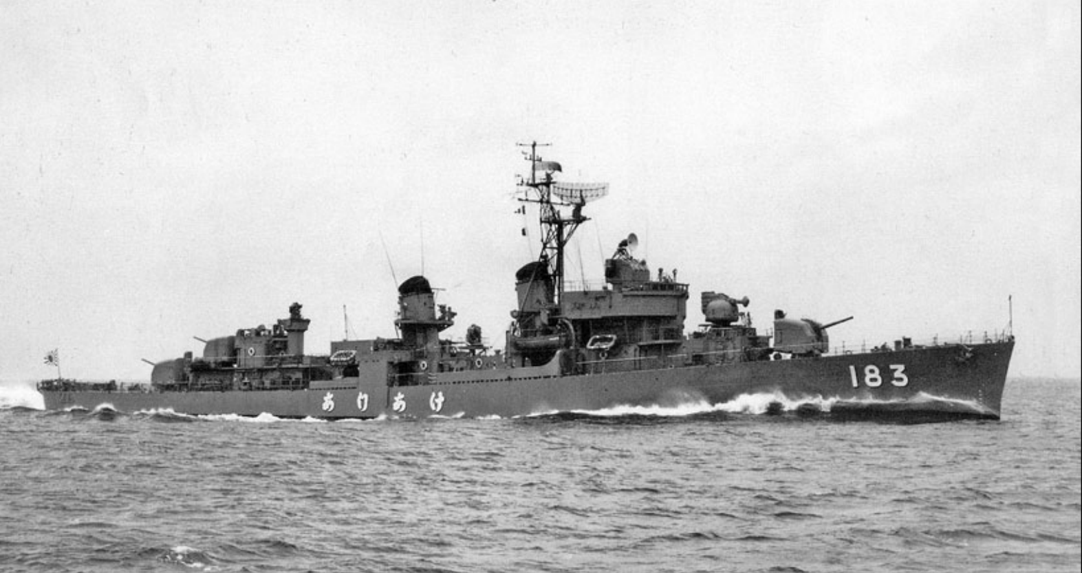
Ariake (eks-Heywood L. Edwards) był natomiast reprezentantem typu Fletcher . Fotografia okrętu z końcowego kresu służby po modyfikacjach. Przed pomostem widoczny miotacz Mk 108 „Weapon Alfa”. Fot. „Ships of the World”
