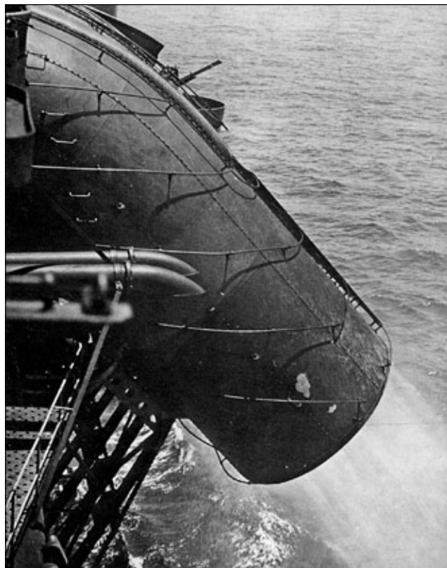
Komin lotniskowca Kaga po modernizacji jednostki. Fot. zbiory Shizuo Fukui
