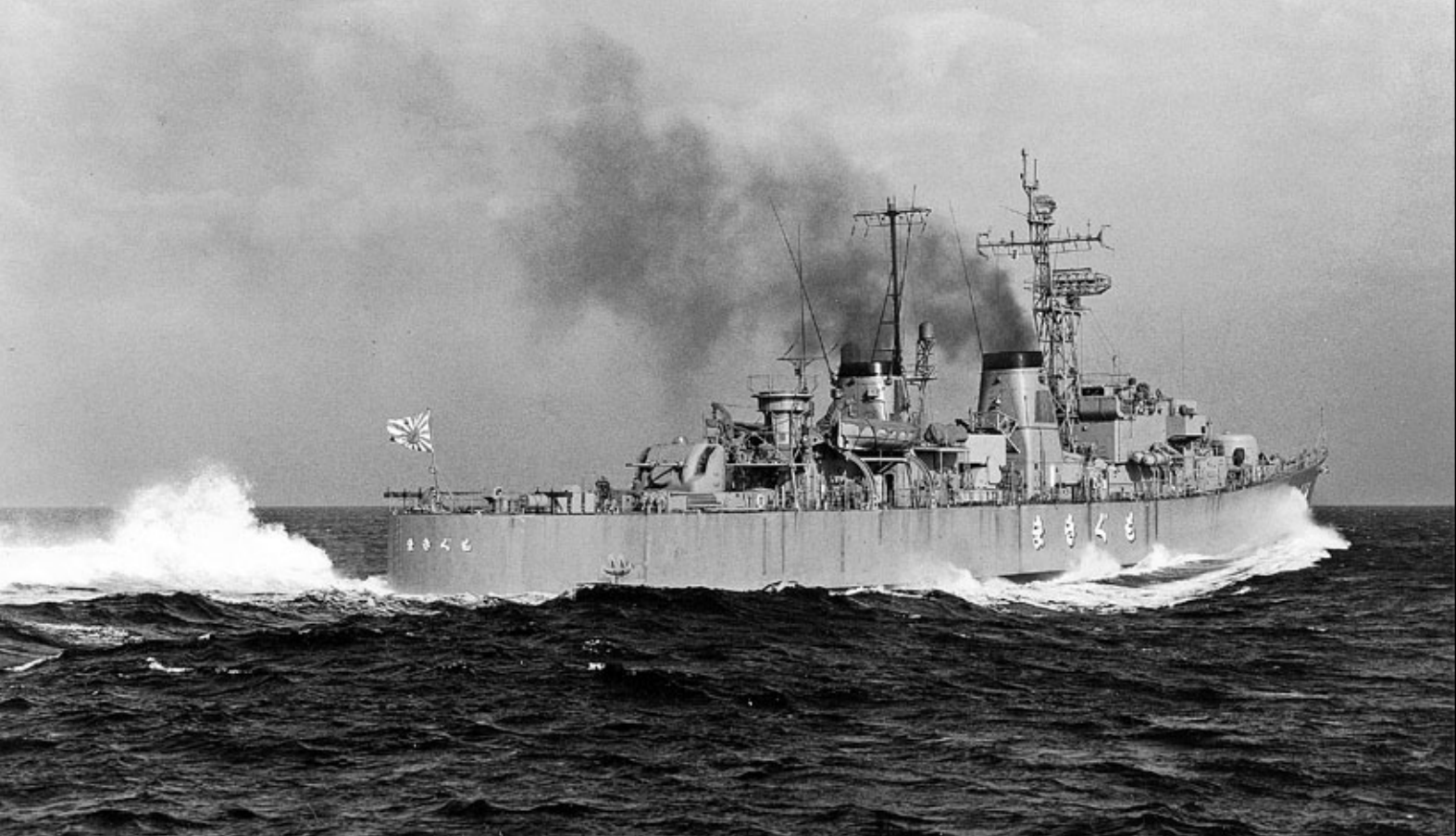
Akigumo typu „Yamagumo” w czasie prób morskich. Zwraca uwagę nowa architektura bryły pomostu i kominów.
