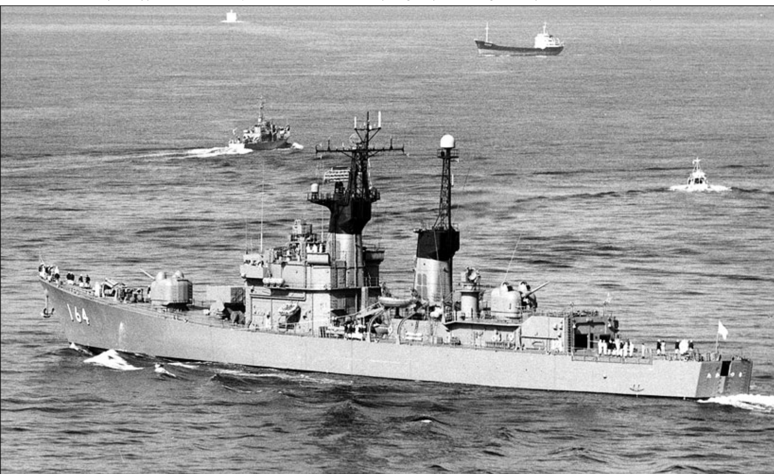
Jeszcze jedno ujęcie Takatsuki z 18 sierpnia 1974 roku. Dobrze widoczny hangar i lądowisko śmigłowców systemu DASH. Fot. „Ships of the World”
