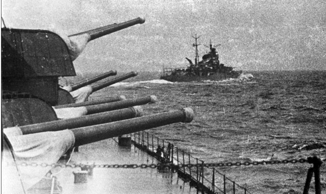
Tone – prototyp unikatowej konstrukcji krążowników ciężkich, w której cała artyleria głównego kalibru została rozmieszczona przed nadbudówką. Miejsce na pokładzie rufowym zostało przeznaczone na wyposażenie lotnicze (2 katapulty i do 6 wodnosamolotów). Fot. „Ships of the World”
