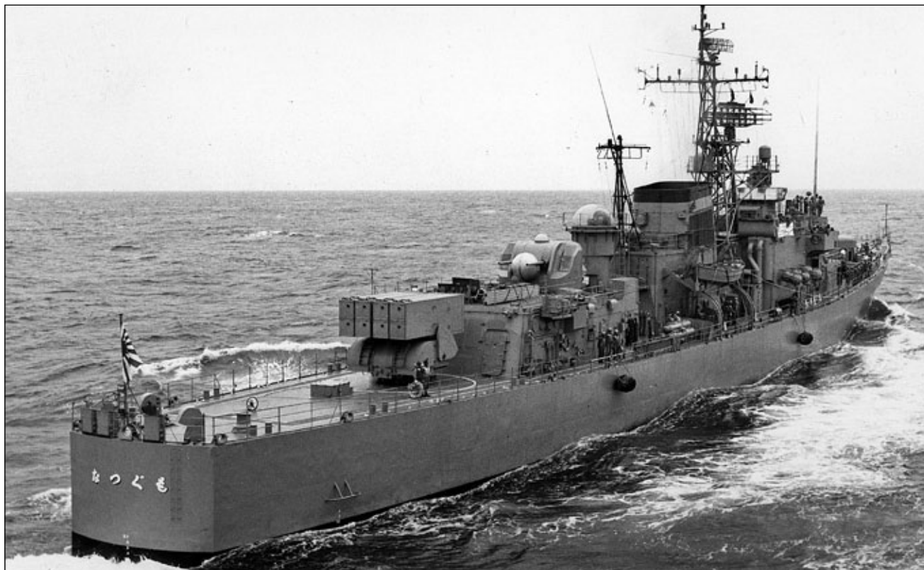
Natsugumo po modernizacji polegającej na zamianie hangaru wyrzutni rakietotorped ASROC.
