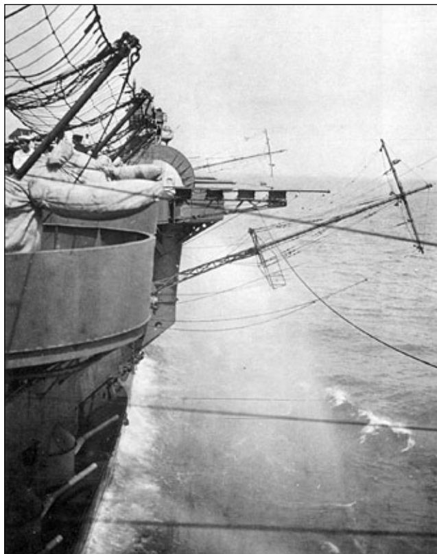
Opuszczone anteny radiowe, w czasie operacji lotniczych na pokładzie lotniskowca Kaga . Fot. zbiory Shizuo Fukui
