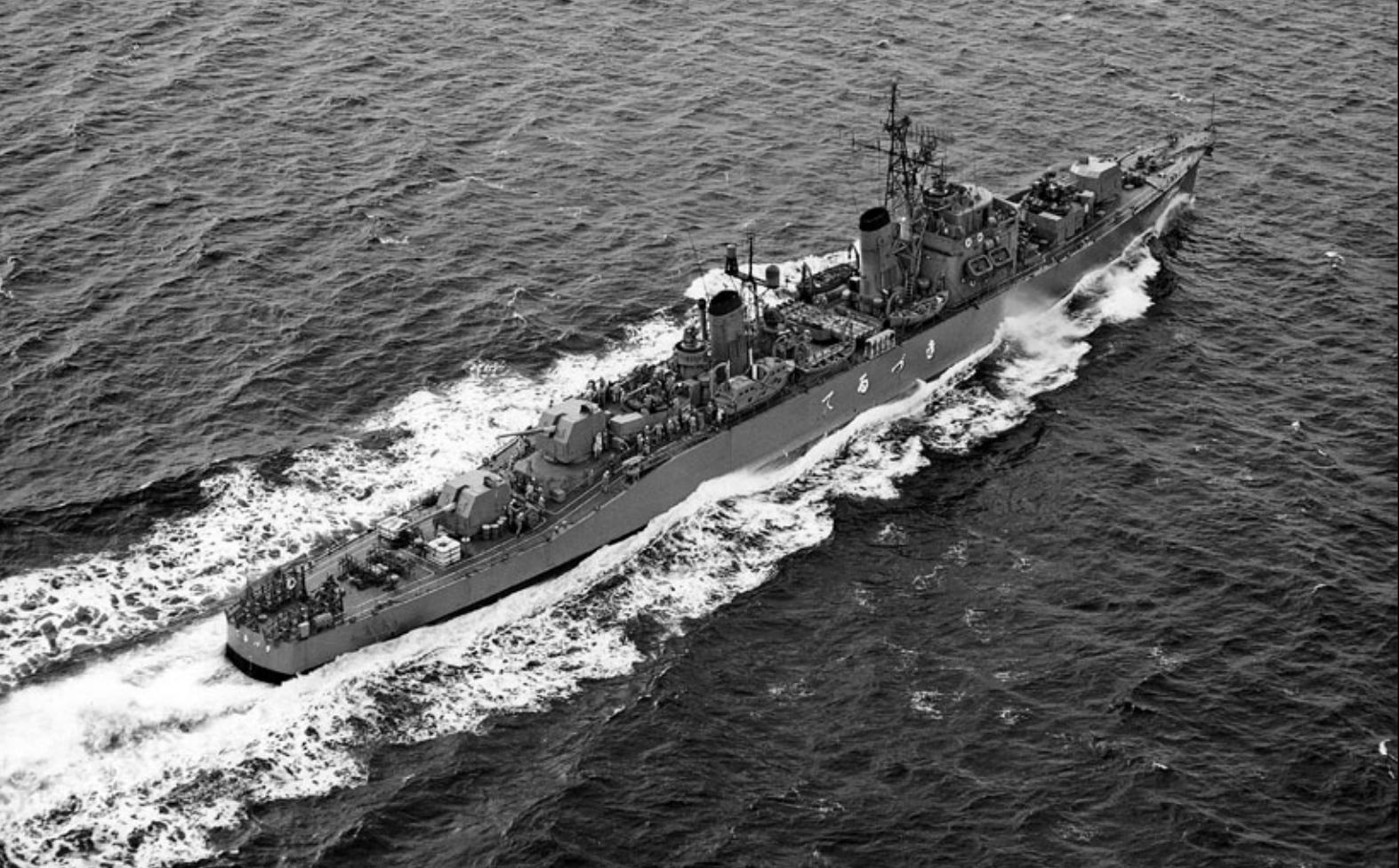
Terezuki , kolejny okręt powyższego typu również na próbach w dniu 5 grudnia 1959 roku. Proszę zwrócić uwagę na dobrze widoczną wyrzutnię torped na śródokręciu. Fot. „Ships of the World”
