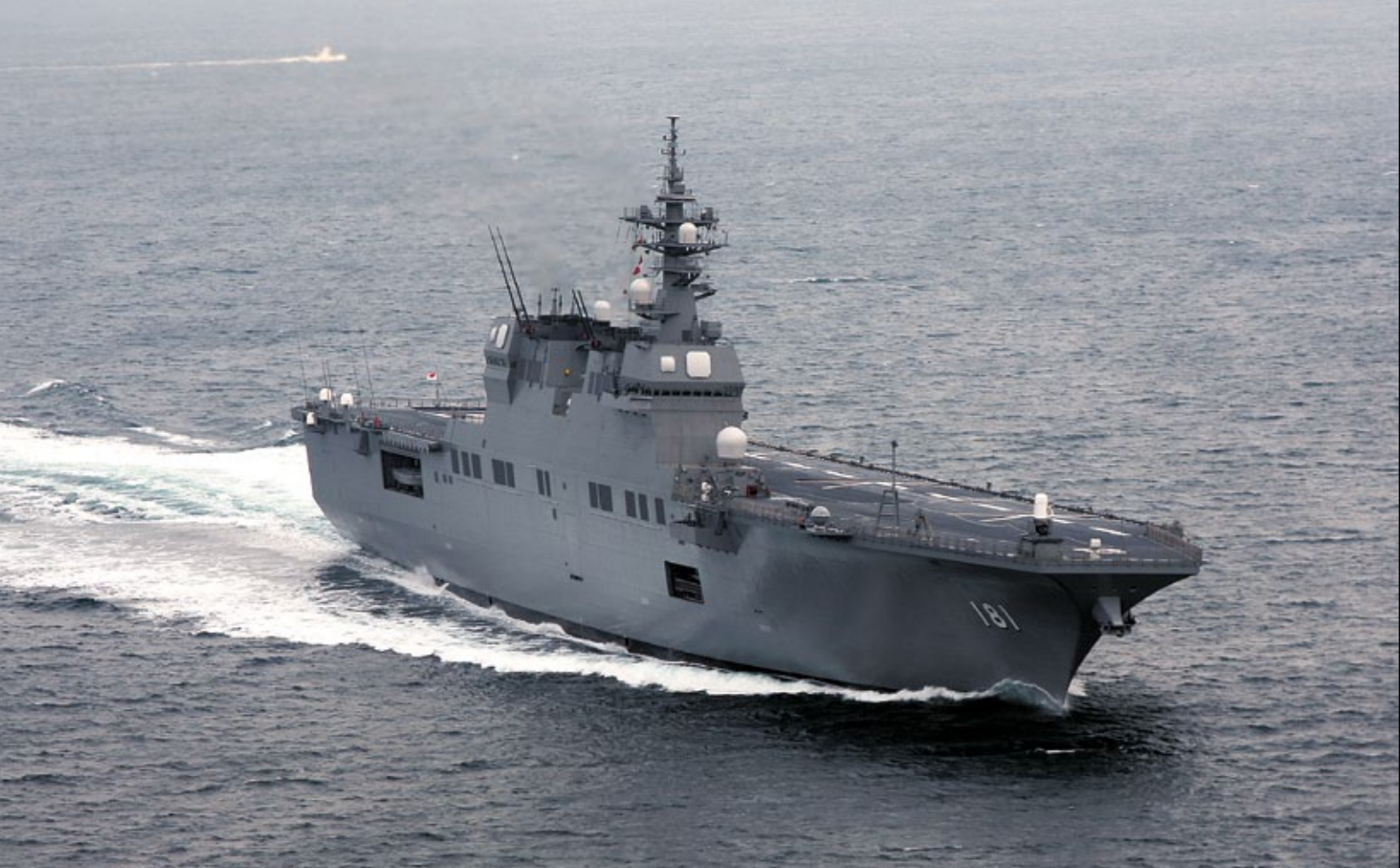
Jeszcze raz Hyūga w czasie prób prędkościowych. Fotografia dobrze również ukazuje rozmieszczenie elektroniki okrętu.
