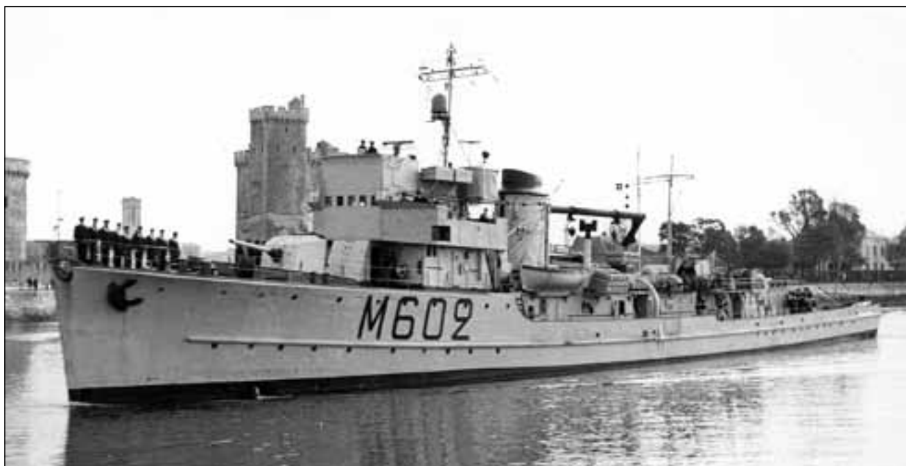
Oise (M 602) eks M 38 w roku 1956. Uzbrojenie plot. w kal. 20 mm składa się z 4 pojedynczych lawet w nokach pomostu i na rufie obok armaty kal. 40 mm. Fot. Marius Bar
