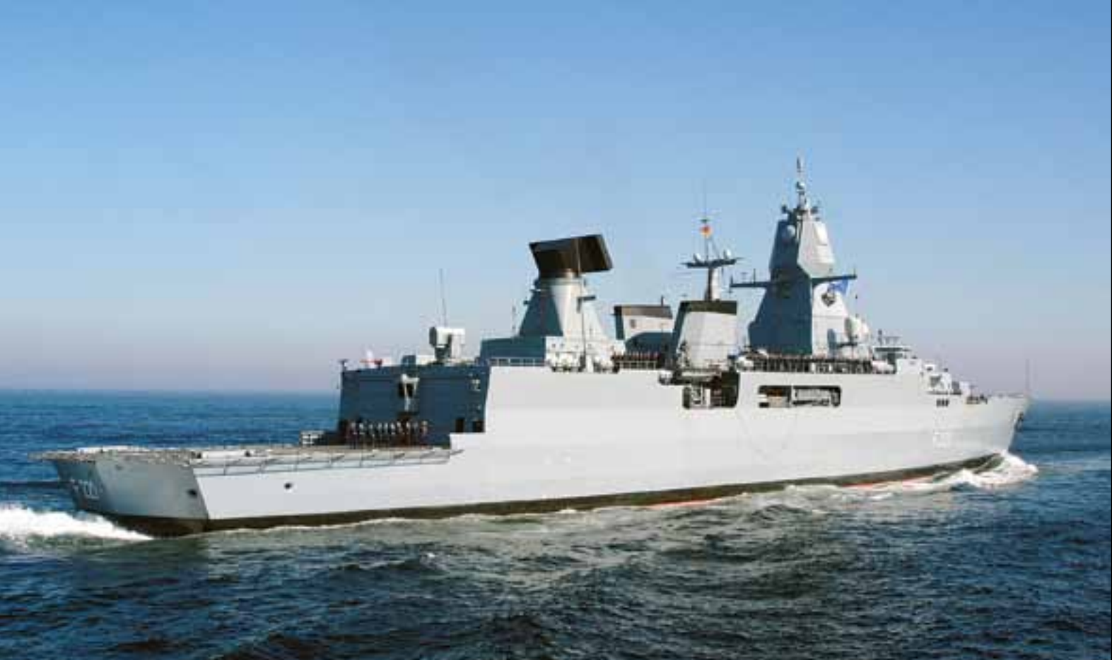
Fregata Hessen od rufy. Widoczny charakterystyczny kształt burt składających się z kilku płaszczyzn połączonych pod dużymi kątami i płynnie przechodzącymi w nadbudówki. Fot. zbiory Leo van Ginderen
