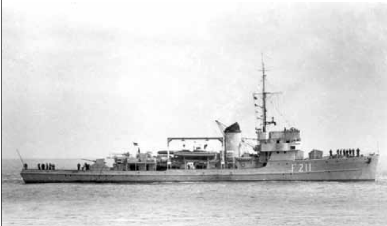
Wespe (F 211) eks Q 76 po przebudowie, tutaj około 1959 r. na Łabie koło Cuxhaven. Uzbrojenie plot. kal. 20 mm obejmuje 4 pojedyncze lawety ustawione w nokach pomostu i na rufowych platformach obok armaty kal. 40 mm. Fot. zbiory Hartmut Ehlers
