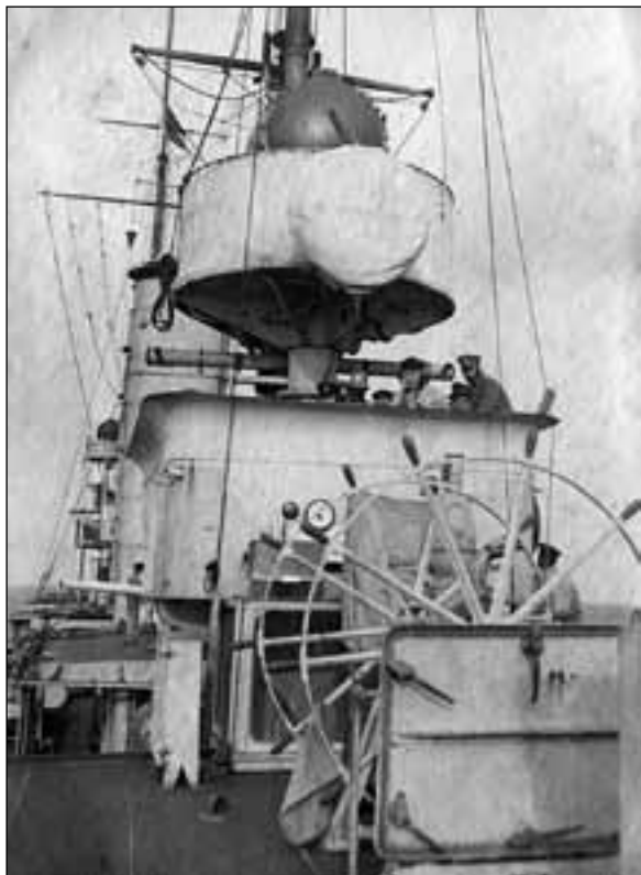
Rufowy mostek Brummera . Widoczny ster ręczny, dalmierz i platforma reflektora na grotmaszcie.
