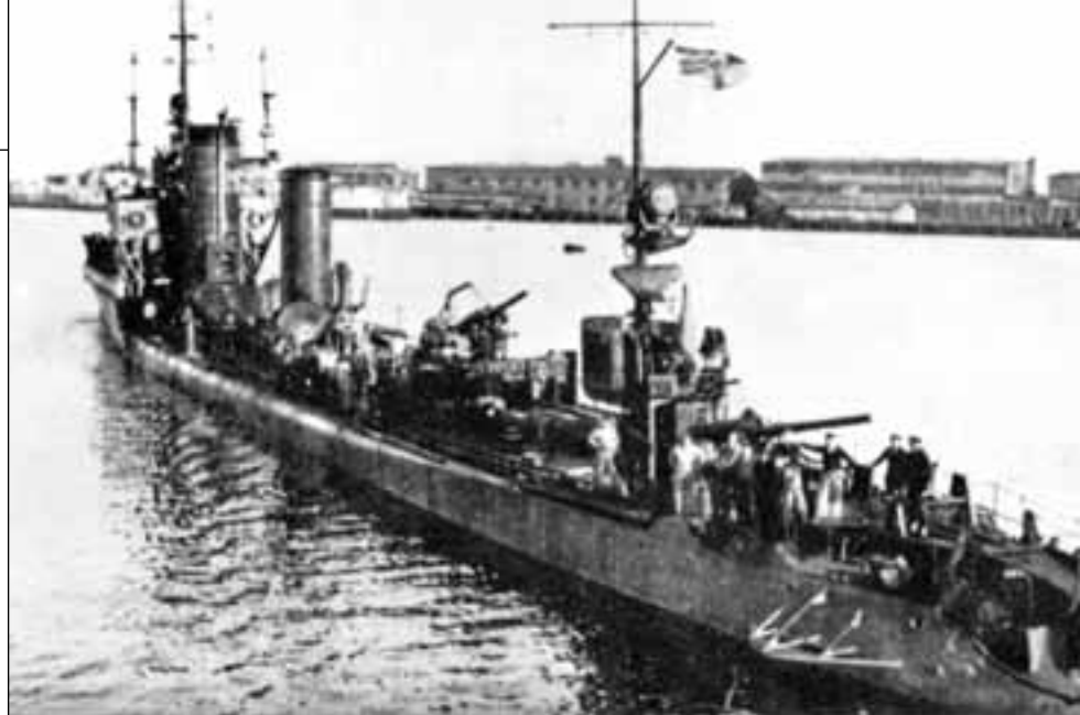
Pomimo, że numery niszczycieli przyznano później, to budowę jednostek typów V 125 i S 131 (na fotografii V 130) ukończono jednak wcześniej, niż opisywanych tutaj dużych niszczycieli. Ten typ to właśnie tzw. 1916-Mob-Typ wypierający maksymalnie do 1170 t, uzbrojony w trzy armaty kal. 105 mm i 6 wyrzutni torpedowych kal. 500 mm. Fot. WZ-Bilddienst
