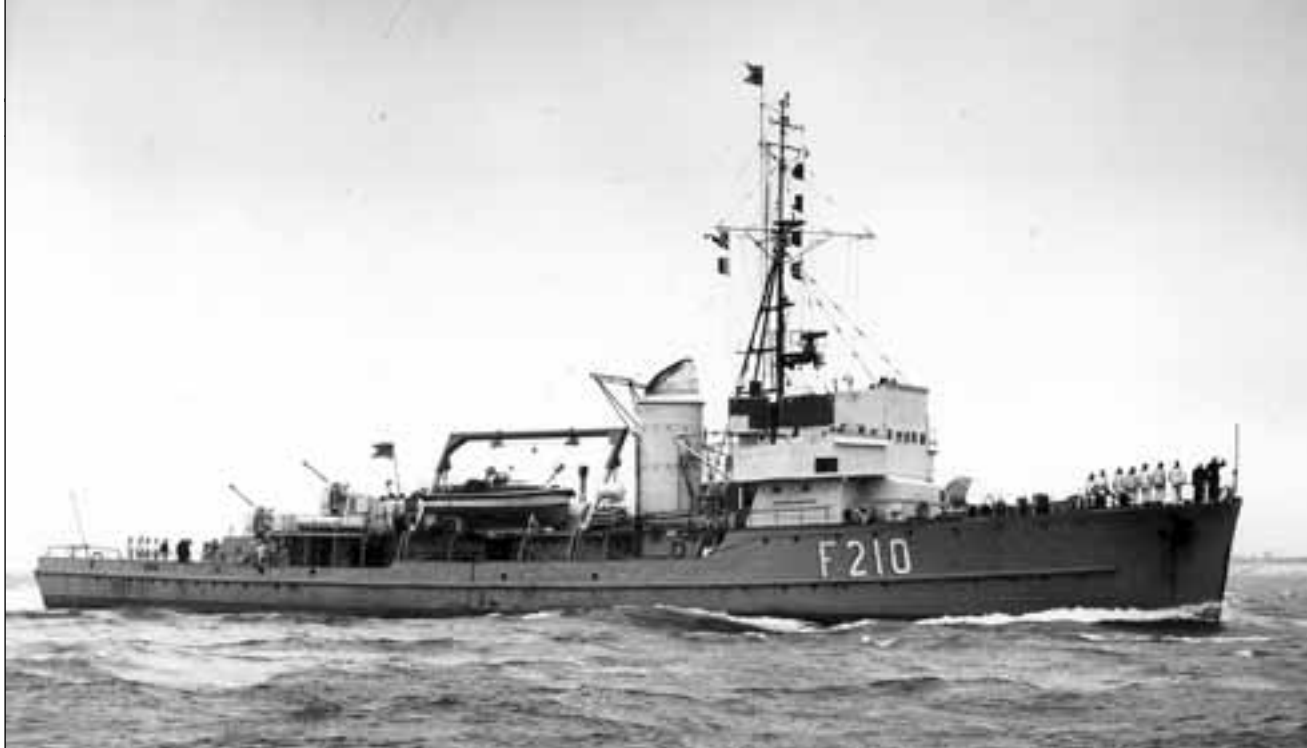
Hummel (F 210) eks Q 75, marzec 1963; wchodzi do Portsmouth. Uzbrojenie kal. 20 mm obejmuje: 2 pojedyncze Oerlikony w nokach pomostu. Trójnożny maszt miał tylko Hummel . Fot. zbiory Hartmut Ehlers
