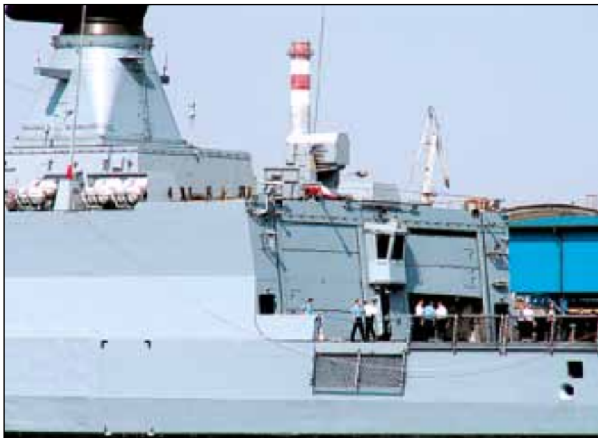
Bliźniacze hangary okrętu przeznaczone do bazowania śmigłowca NHI NH-90. Między nimi widoczne stanowisko kontroli lotów. Fot. Andrzej Nitka
