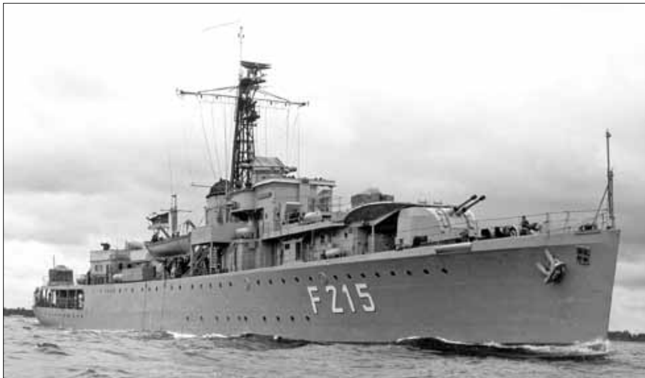
Graf Spee , około 1962 w Zatoce Kilońskiej po zamontowaniu nowego uzbrojenia (2 x 102 mm, 3 x 40 mm).
