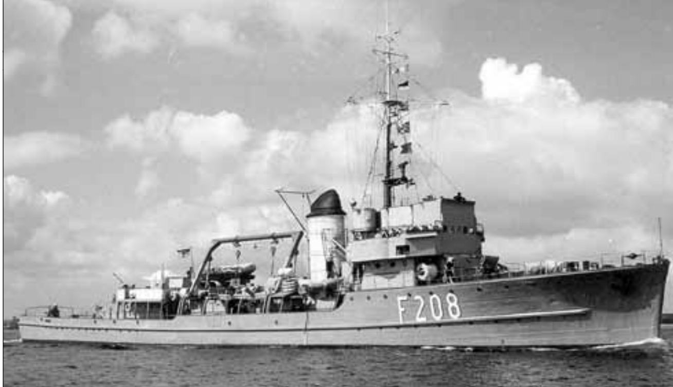
Bremse (F 208) eks Q 77, początek lat 60. w Zatoce Kilońskiej. Uzbrojenie plot. kal. 20 mm obejmuje 4 zdwojone podstawy umieszczone w nokach pomostu i na rufowych platformach obok armaty kal. 40 mm. Fot. zbiory Hartmut Ehlers
