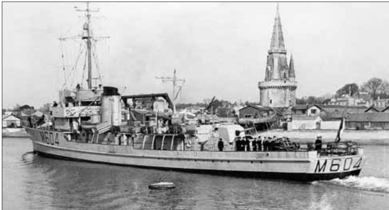
Yser (M 604) eks M 85 w roku 1956. Uzbrojenie plot. w działka kal. 20 mm składa się z 4 pojedynczych lawet w nokach pomostu i na rufowych platformach obok armaty kal. 40 mm. Fot. Marius Bar
