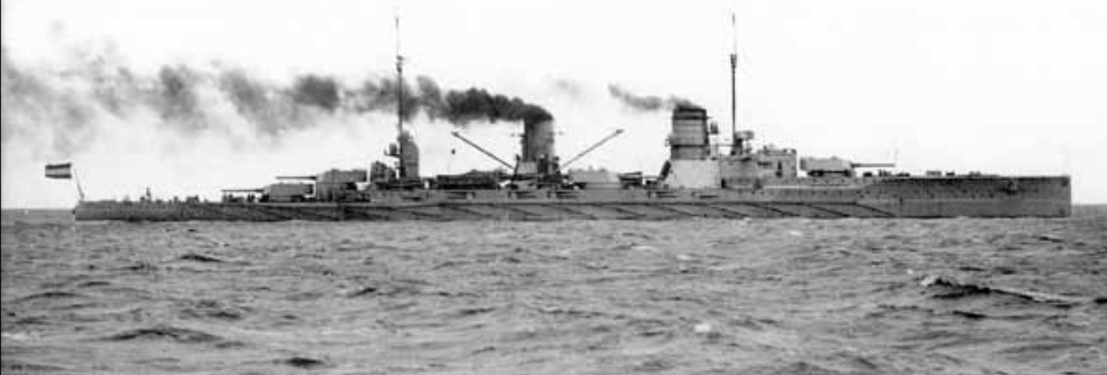
Seydlitz w trakcie prób stoczniowych, krążownik nie jest jeszcze oficjalnie w służbie o czym świadczy bandera handlowa na rufie, zwraca uwagę brak sieci przeciwtorpedowych i brakujące na masztach platformy obserwacyjne. Fot. zbioru Andrzej Danilewicz
