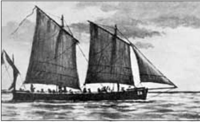
Kanonenschaluppe Nr. 26, czyli wiosłowa szalupa uzbrojona nr 26 – zbudowana w r. 1849 według wzorów duńskich, długość 19 metrów, zmobilizowana w latach 1849 i 1864. W latach 1862-1870 wraz innymi skreślona z listy, następnie wykorzystane jak promy lub pontony pod mosty.
