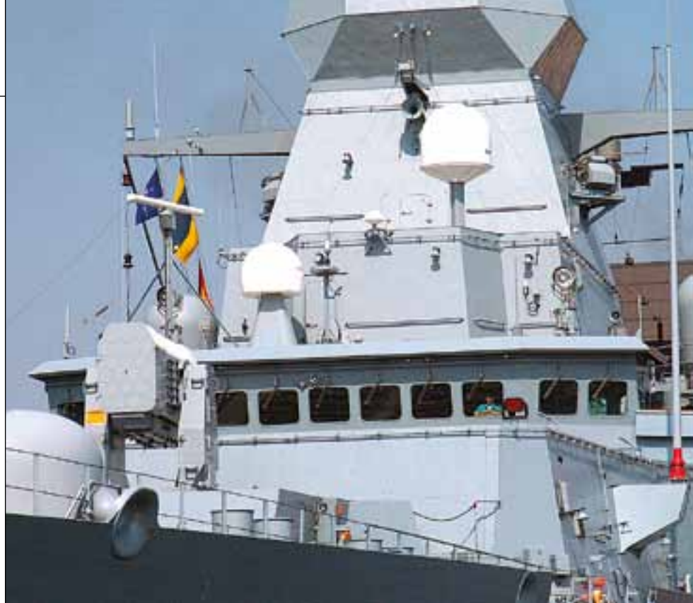
Pokład dziobowy niemieckiej fregaty. Przed mostkiem widać armatę pokładową Oto Melara Compact oraz dziobową wyrzutnię rakiet plot./prak. RAM Block 1 HAS. Fot. Andrzej Nitka
