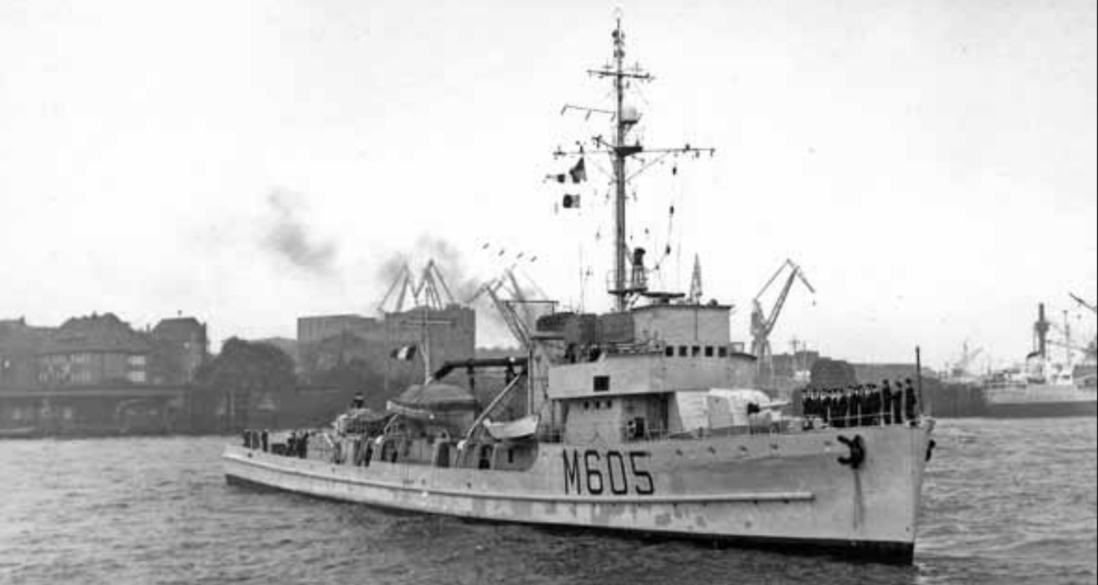
Ailette (M 605) eks M 24 w roku 1954 w trakcie wizyty w Hamburgu. Uzbrojenie w działka plot. kal. 20 mm składa się z 2 pojedynczych lawet ustawionych w nokach pomostu. Fot. Marius Bar
