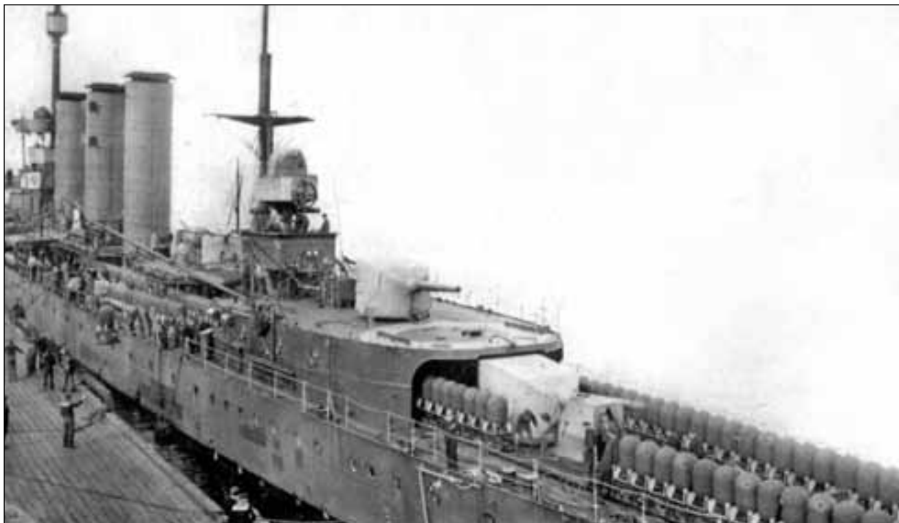
Żaładunek min na Bremse , dobrze widoczne również rufowe działa kal. 150 mm.
