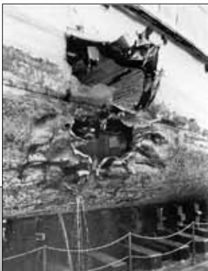
Eks Wespe, około lat 1965/66 w doku arsenału morskiego w Wilhelmshaven z widocznym trafieniem, prawdopodobnie rakietą, która uderzyła w lewą burtę poniżej pokładu głównego przed frontową krawędzią pomostu (przedział X). Fot. zbiory Hartmut Ehlers
