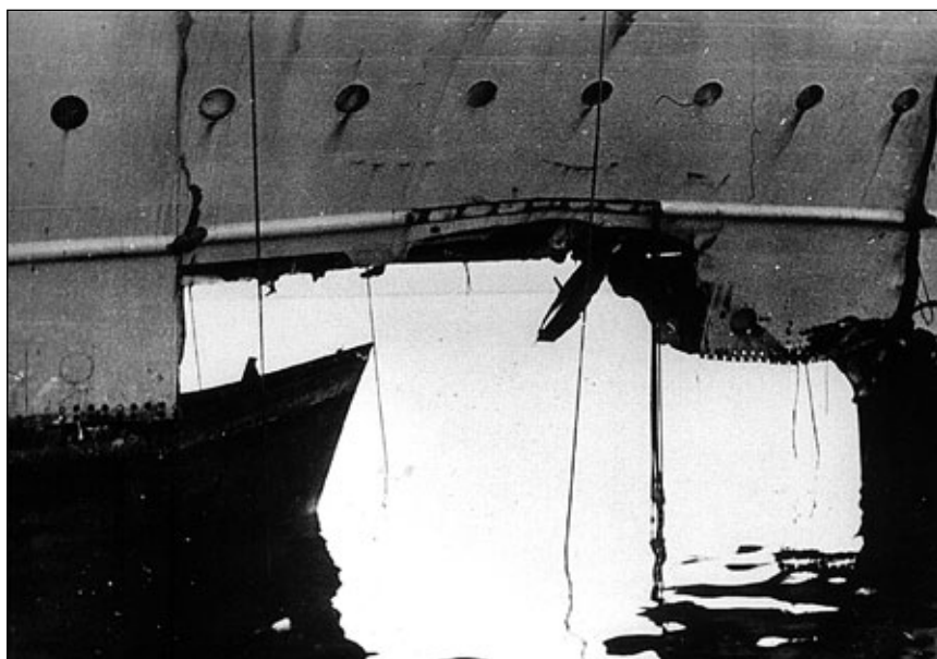
Gneisenau po uszkodzeniach zadanych przez brytyjski okręt podwodny Clyde . Dziób został przebity na wylot. Fot. zbiory Siegfried Breyer
