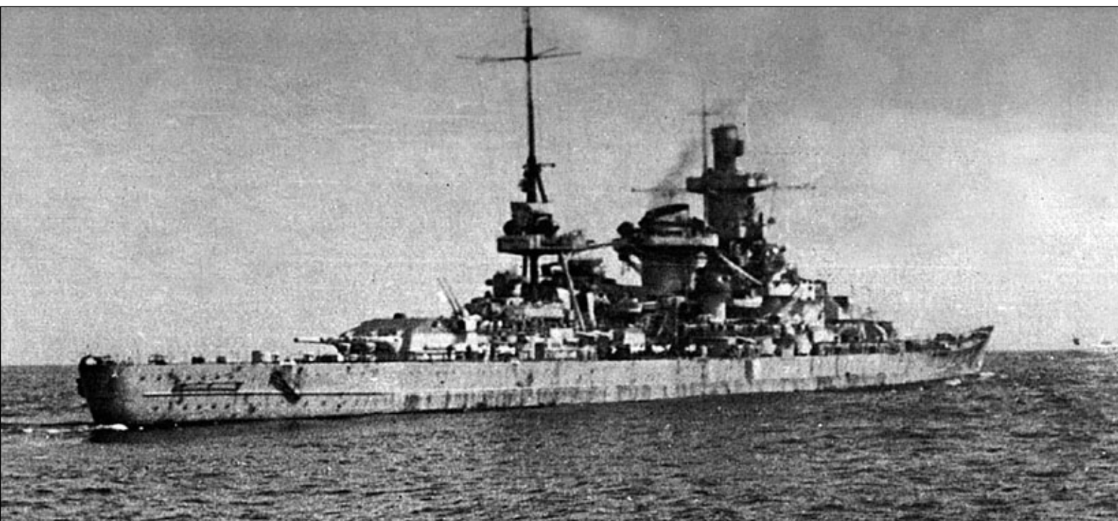
Fotografia Scharnorsta wykonana 6.03.1941 z pokładu U 124 podczas operacji „Berlin”. Dobrze widoczny wzdłuż burty kabel urządzenia demagnetyzacyjnego (MES), założonego jesienią 1940. Fot. zbiory Siegfried Breyer
