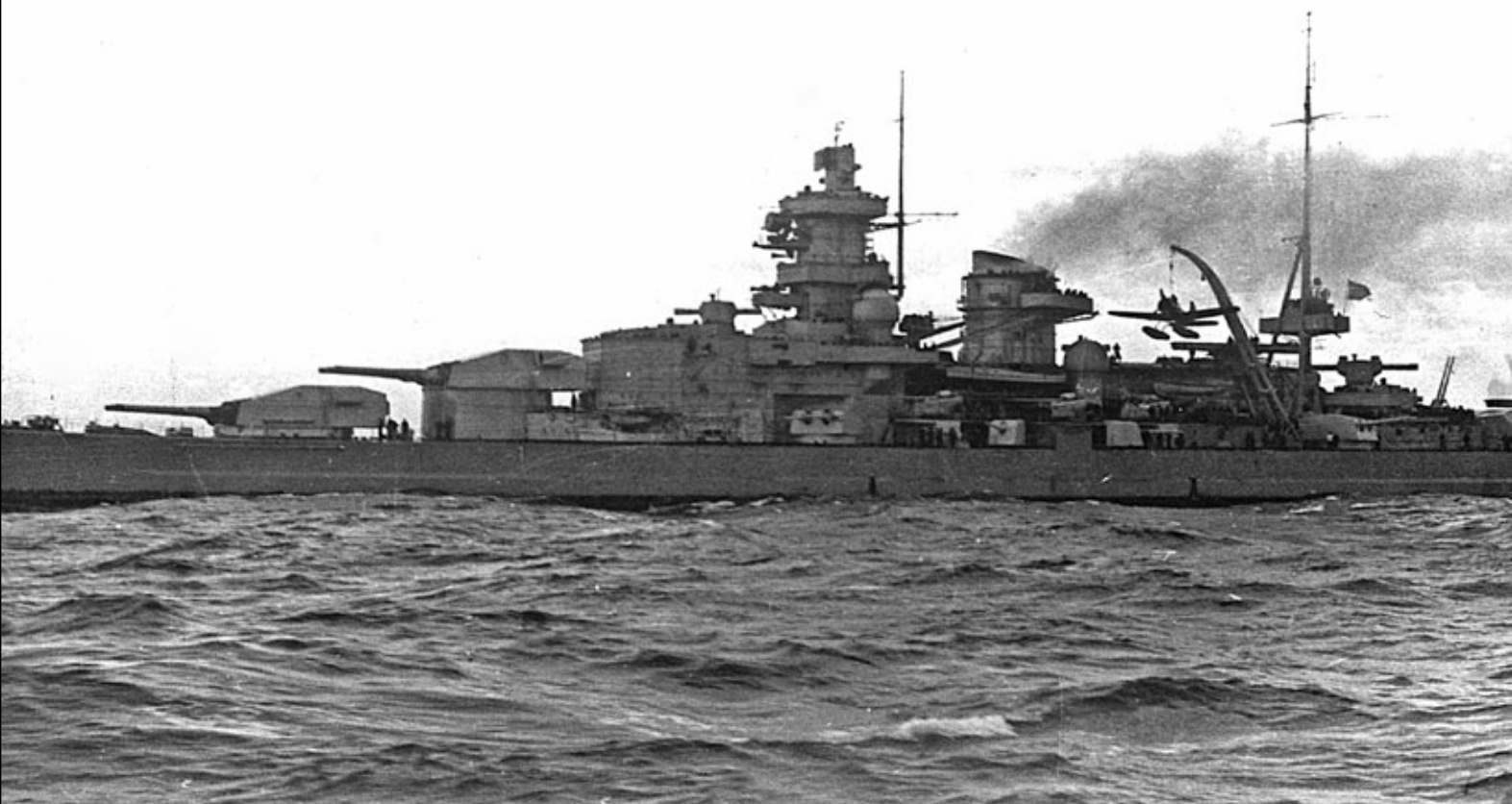
Scharnhorst . Na frontowej ścianie ustawionego na wieży dowodzenia dalmierza zainstalowana już została antena radaru FuMO 22. Za pomocą lewoburtowego dźwigu na katapultę wędruje rozpoznawcze Arado 196. Fot. zbiory Siegfried Breyer
