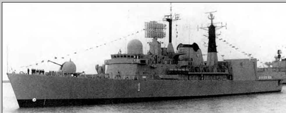
Argentyński niszczyciel rakietowy Hercules (D 1) po zabudowaniu nowego hangaru.
