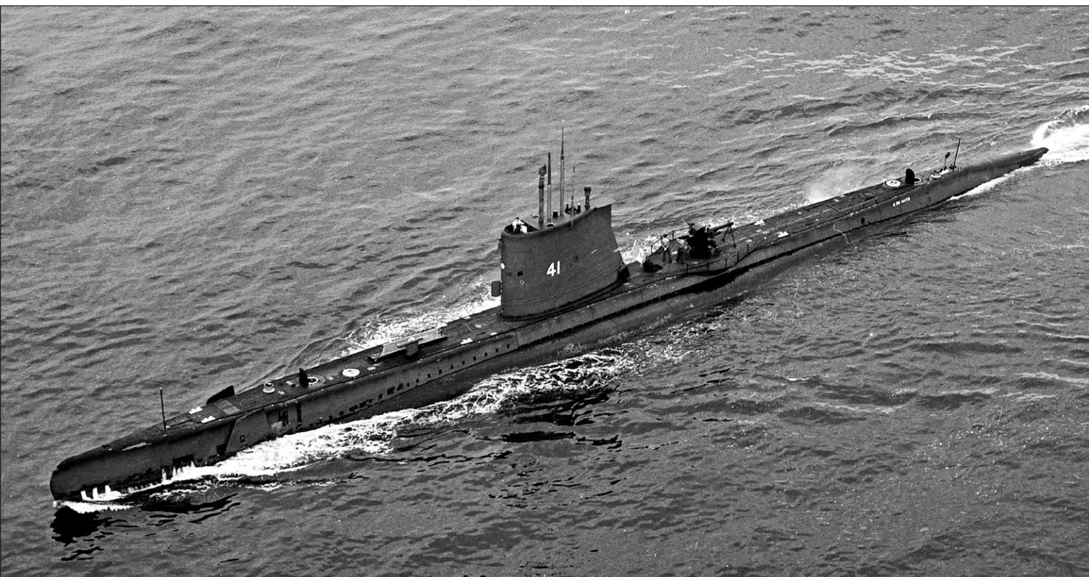
Kolejna fotografia SS-41 Dos de Mayo , tym razem z czerwca 1966 roku. Widoczny nowy kształt kiosku po modernizacji, lecz działo kal. 127 mm za nim pozostawiono. Fot. zbiory Leo Van Ginderena
