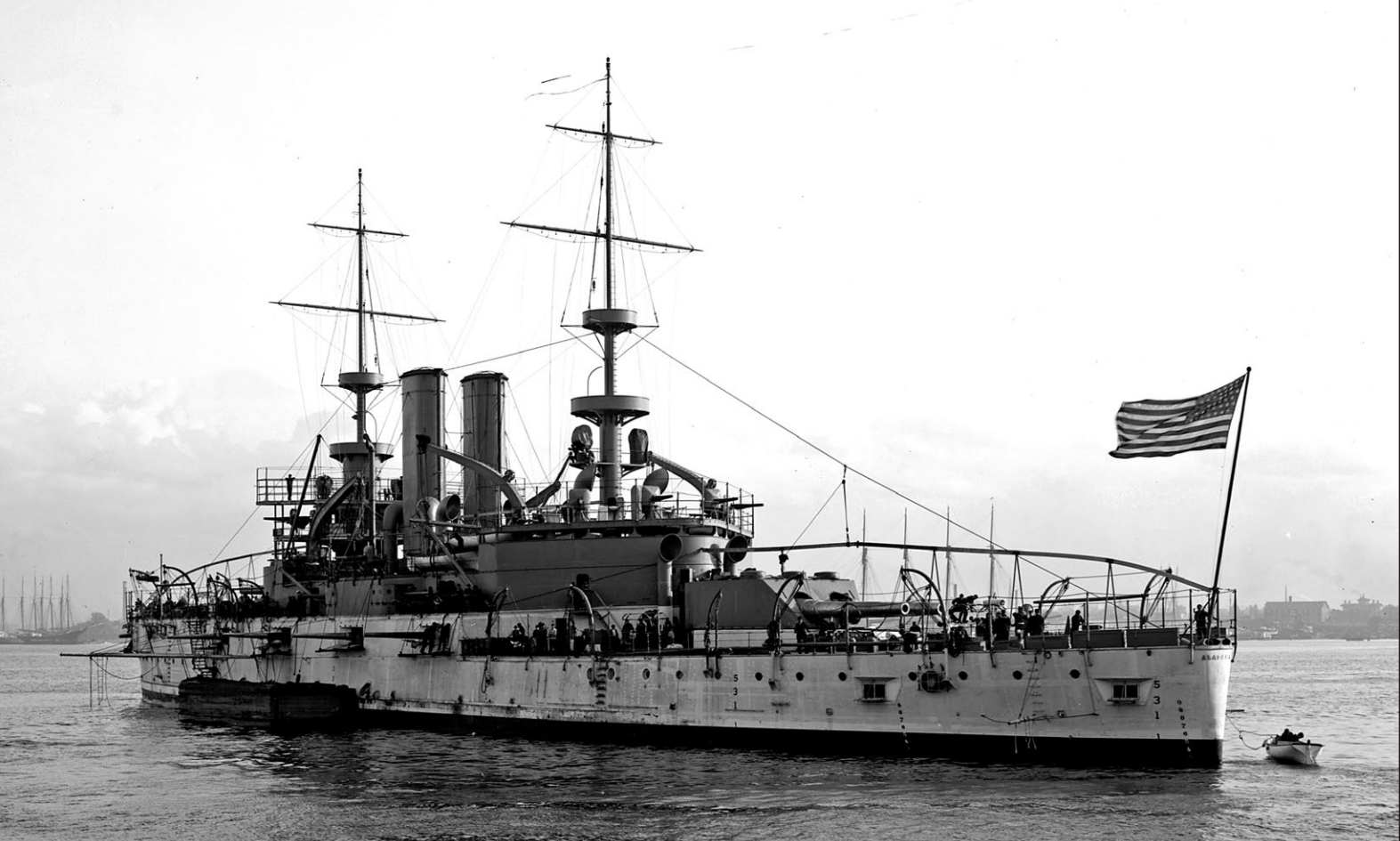
Na pancernikach typu „Illinois”, jako jedynych amerykańskich okrętach tej klasy, zastosowano układ odprowadzania spalin poprzez dwa kominy usytuowane obok siebie. Tutaj: rufowe ujęcie Alabamy. Fot. Library of Congress
