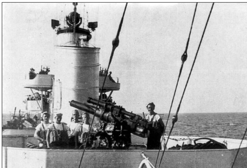
120 mm haubica OTO wz. 1933 na środkowej platformie niszczyciela typu „Soldati”
