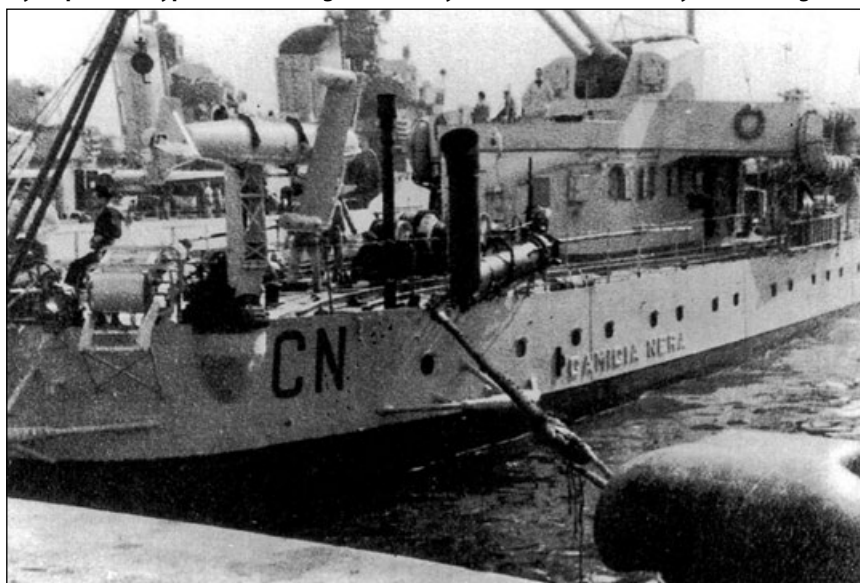
Rufa niszczyciela Camicia Nera , 1941 rok. Dobrze widoczna zrzutnia 50-kg bomb głębinowych, parawan typu „S” oraz rura generatora dymu. Fot. zbiory Erminio Bagnasco
