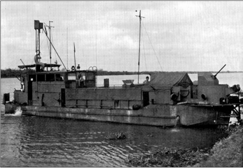
Okręt dowodzenia LCM zacumowany na brzegu rzeki Mekong. Jego taki a nie inny charakter zdradza ilość masztów radiowych. Fot. ECPA
