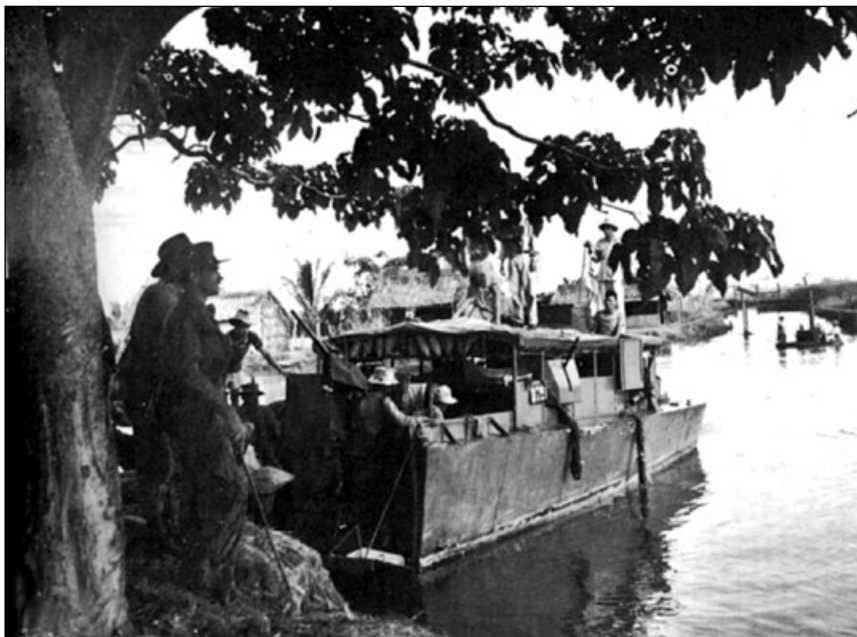
Francuska wersja łodzi LCVP Engin d'Assaut w najbardziej na południe wysuniętym rejonie Indochin Francuskich - prowincji Ca Mau w Kochinchinie, zdjęcie wykonane w 1953 roku. Widoczna na burcie pancerna tarcza ze stanowiskiem karabinu maszynowego jest w 100% efektem inwencji twórczej załogi lub lokalnej jednostki remontowo-naprawczej Dinassaut . Standardowo uzbrojeniem EA był niemiecki km MG 151. Fot. zbiory Gérarda Gariera
