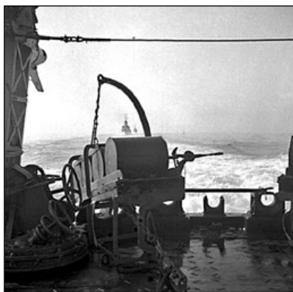
50 kg bomby głębinowe (z lewej), 432/302 mm pneumatyczny miotacz (w środku) oraz niemiecki miotacz typu „G” (z prawej) na niszczycielach typu „Soldati”.
