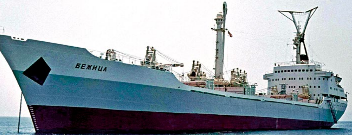
Biežica należał do drugiej grupy jednostek kosmicznej floty ZSRR. Widoczne charakterystyczne anteny łączności satelitarnej przed kominem. Fot. Moskowskij Muzej morskogo kosmicheskogo flota
