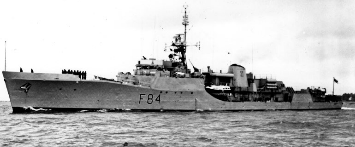
Exmouth w nowej konfiguracji jako okręt doświadczalny nowej siłowni złożonej z turbin gazowych, ujęcie z 1974 roku. Z racji tego zabudowano też nowy komin. Fot. zbiory Hartmута Ehlersa
