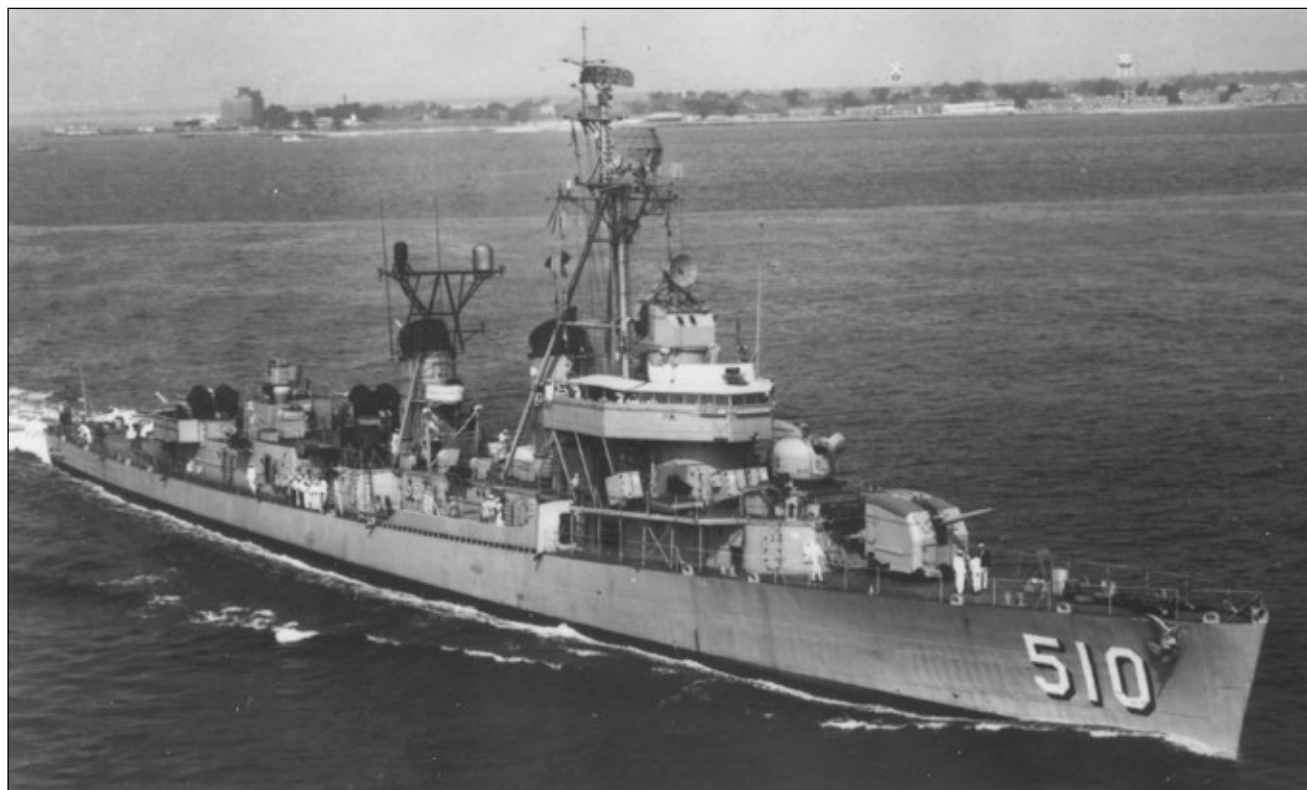
Niszczyciel Eaton (DD-510 eks- DDE-510) na przełomie lat 1968/69, kilka tygodni przed dezaktywacją „Weapon Alpha” i prawoburtowy „Hedgehog” z pojemnikami na gotowe do użycia pociski, widoczne na dziobowym pokładzie nadbudówki. Fot. zbiory Hartmuta Ehlersa
