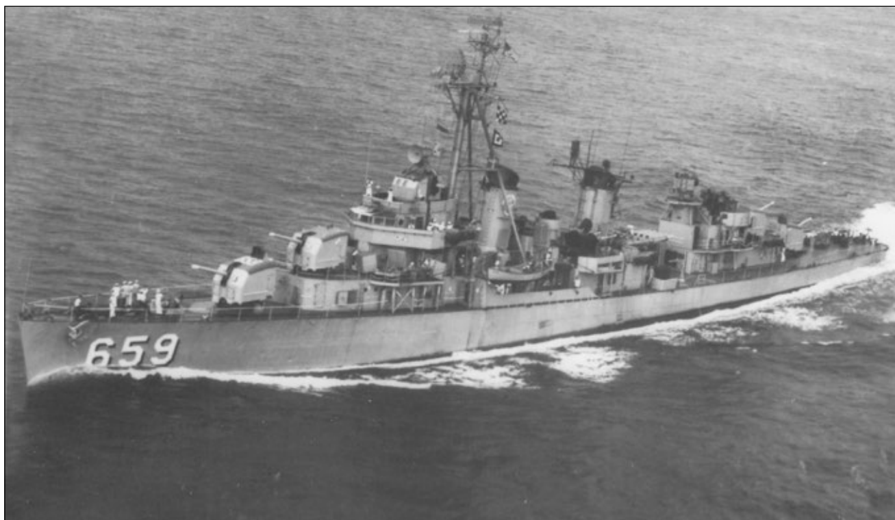
Dashiell (DD-659) typu „Daly”, 1957 rok. Widoczne 2 miotacze pop „Hedgehog” przed pomostem.
