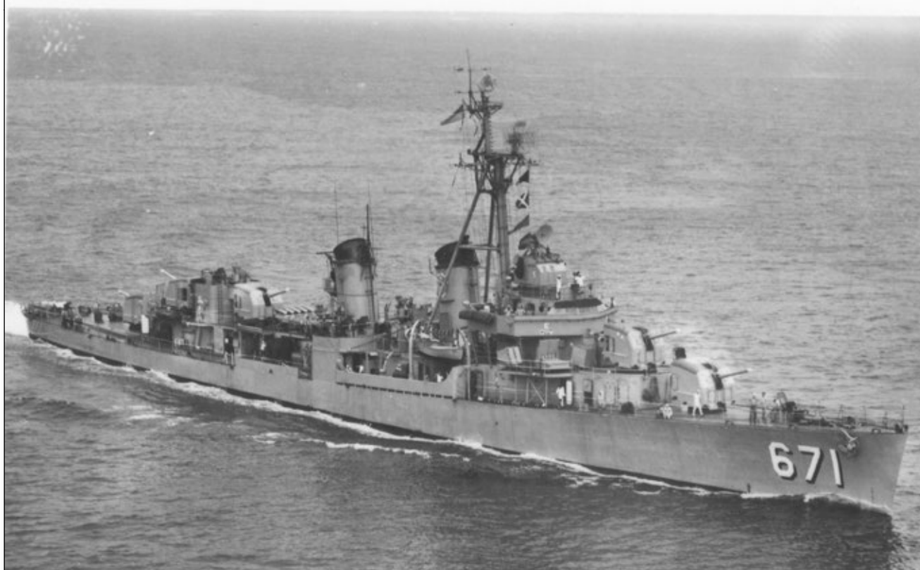
Gatling (DD-671) typu „La Vallette” w 1957 roku. Widoczne 2 miotacze pop „Hedgehog” przed pomostem.
