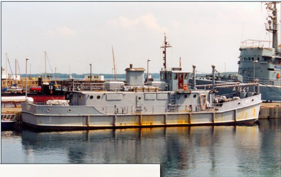
Pływająca stacja ładowania akumulatorów okrętów podwodnych LP 1 w bazie Eckernförde, 25 lipca 2001 r. Fot. © Hartmut Ehlers
