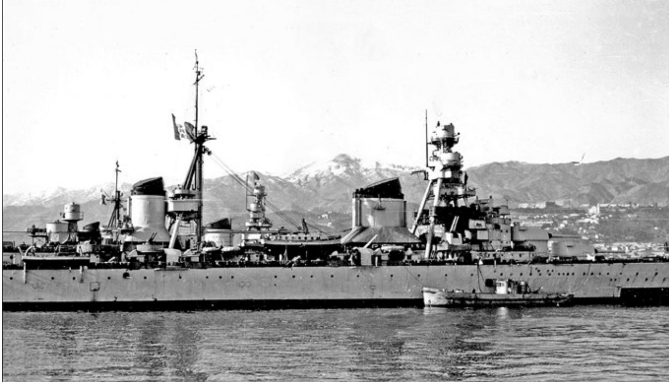
Trieste w Messynie w 1941 roku. Fotografia ta dobrze ukazuje rozmieszczenie dział kal. 100 mm, 37 mm oraz burtowych wyrzutni torpedowych. Fot. zbiory Leo van Genderena
