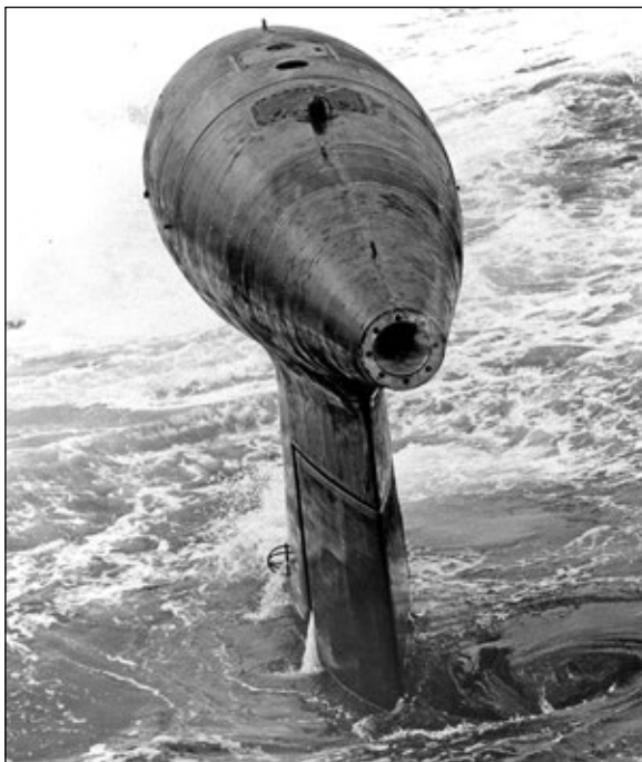
Opływka holowanej anteny infradźwiękowej na okręcie projektu 671RTM ( Victor III ). Fot. MoD (UK), grzecznościowo John Jordan
