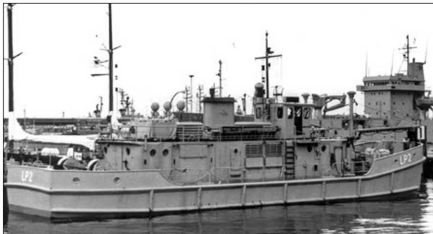
Pływająca stacja ładowania akumulatorów okrętów podwodnych LP 2 w kilonńskiej bazie 24 czerwca 1990 r. Za nim widoczny tender Main . Fot. © Hartmut Ehlers
