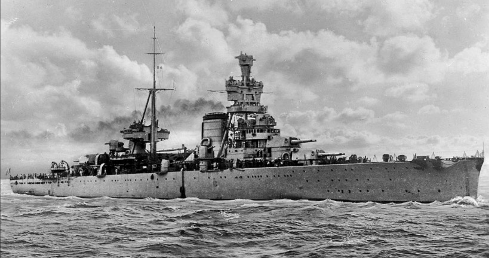
Trieste w 1931 roku po wzmocnieniu masztu dziobowego z dodatkowymi podporami.
