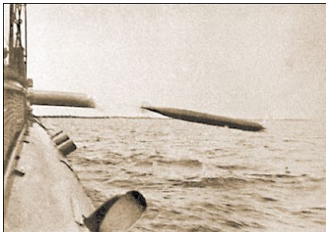
Moment wystrzelenia torpedy z jednego z torpedowców. Widoczne na burcie rury miały ułatwiać wentylację pomieszczeń okrętu, szczególnie siłowni. Fot. zbiory Hansa Lengerena
