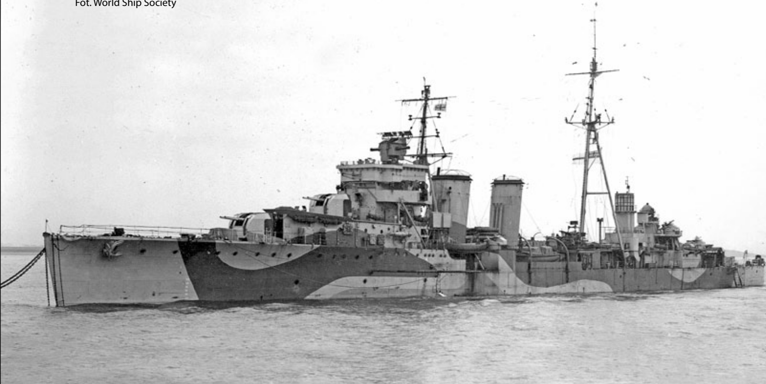
Caledon po przebudowie na krążownik przeciwlotniczy. Fot. World Ship Society
