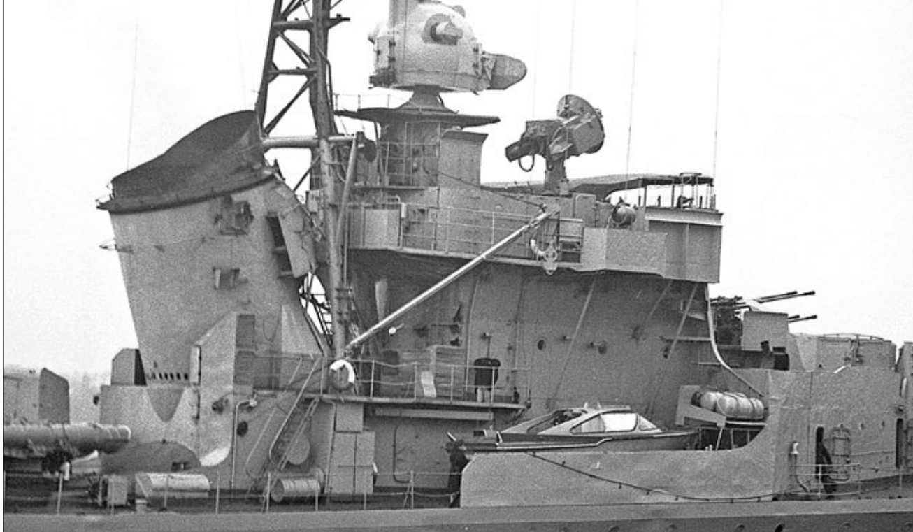
Ujęcie nadbudówki z pmostem niszczyciela Swietłyj z 1970 r. Nad pomostem widoczny okrągły radar „Fut-B”, za nim koliste stanowisko SWP-42-50. Z boku pomostu widoczny kuter proj. 378.
