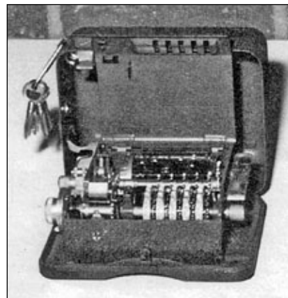
Jedna z maszyn szyfrujących Hagelin C-36. Za pomocą jej włoskiej wersji C-36 m szyfrowano m. in. radiotelegramy – które od czerwca 1941 były na bieżąco rozszyfrowywane – dotyczące płynących do Afryki Północnej konwojów.
