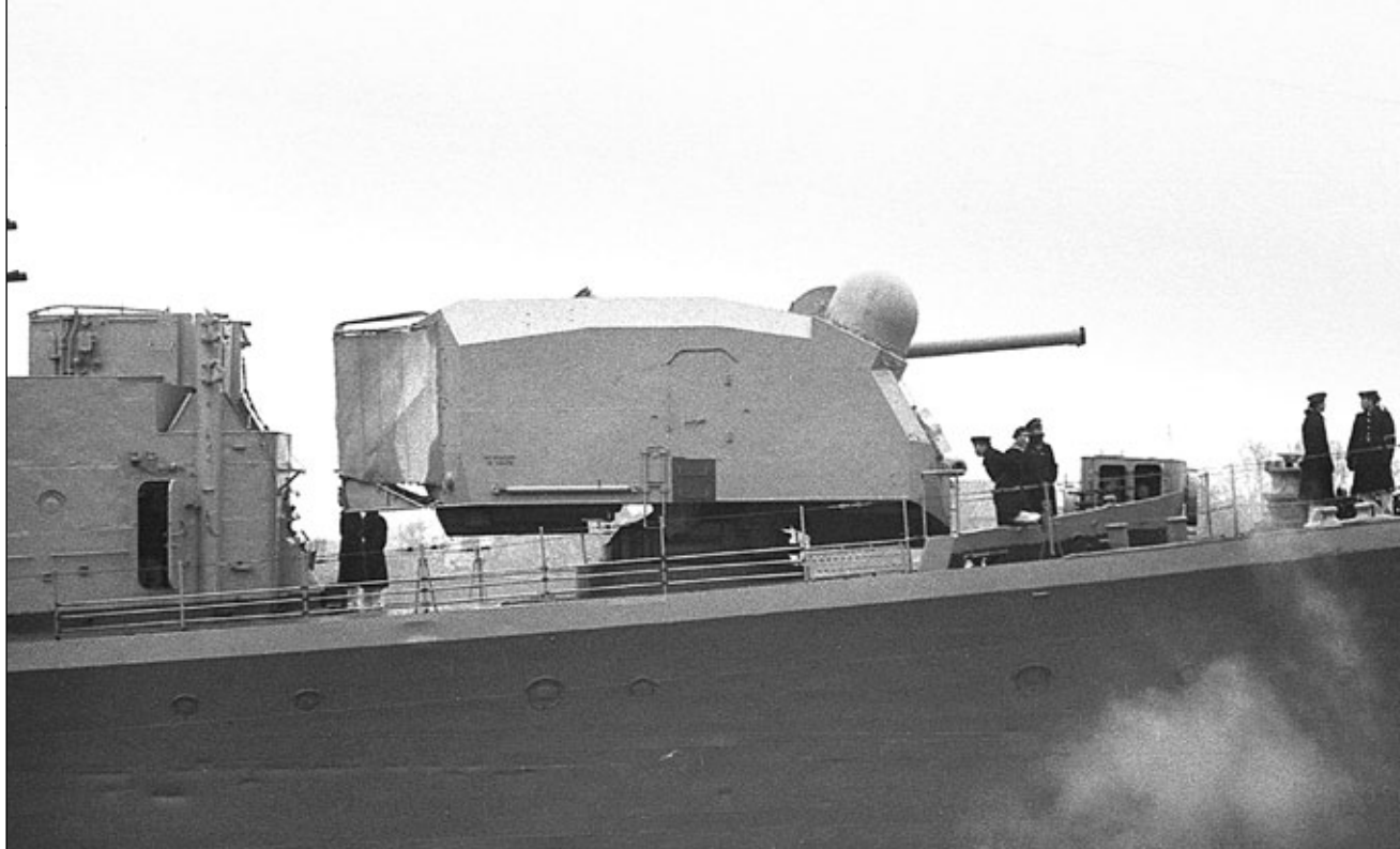
Dziobowa wieża działowa SM-2-1 kal. 130 mm, widoczna kopuła radaru artyleryjskiego.
