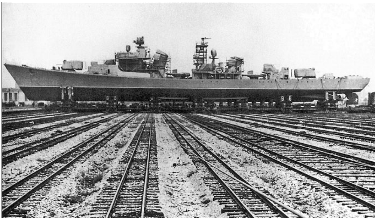
Niszczyciel Spiesznyj przygotowany do bocznego wodowania w stoczni im. A.A. Żdanowa w Leningradzie.
