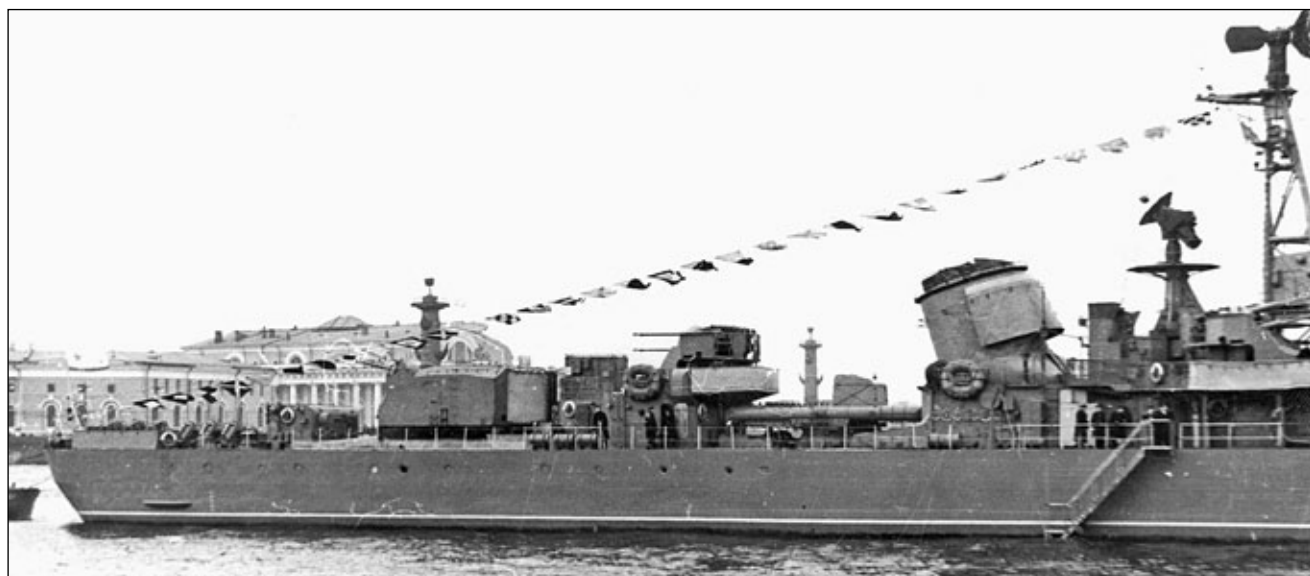
Trzy ciekawe ujęcia niszczyciela Sozhatielnij wykonane w Leningradzie w 1957 roku. Ukazują one w ciekawy sposób poszczególne elementy zewnętrznego okrętu – na grotmaszcie radar „Rif”. Fot. copyright Ota Janeček
