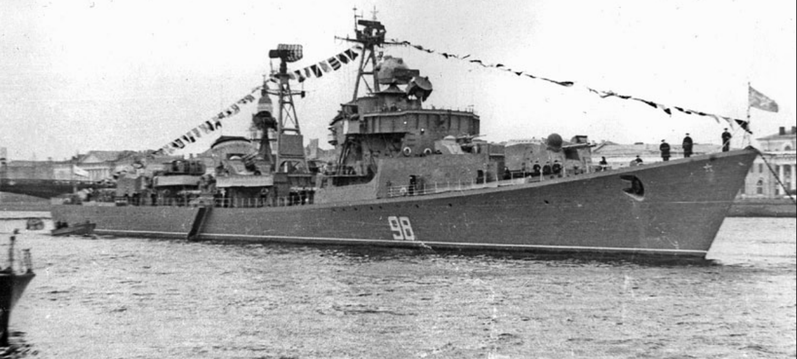
Trzy ciekawe ujęcia niszczyciela Sozhatielnij wykonane w Leningradzie w 1957 roku. Ukazują one w ciekawy sposób poszczególne elementy zewnętrznego okrętu – na grotmaszcie radar „Rif”. Fot. copyright Ota Janeček
