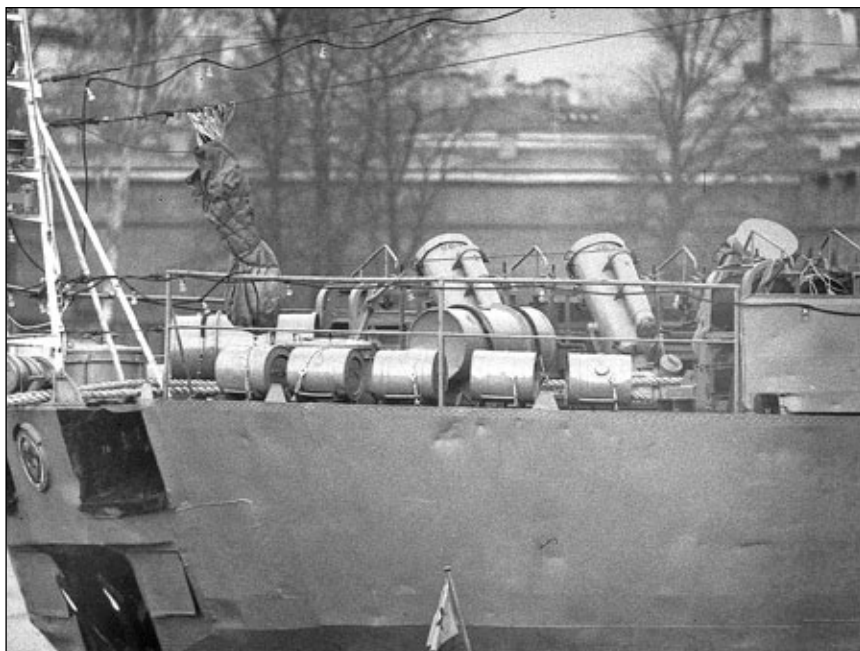
Ujęcie rufy – widoczne miotacze BMB-2 a na pawęży rufowej tory minowej, pod nimi pokrywy żrutowi bomb głębinowych.
