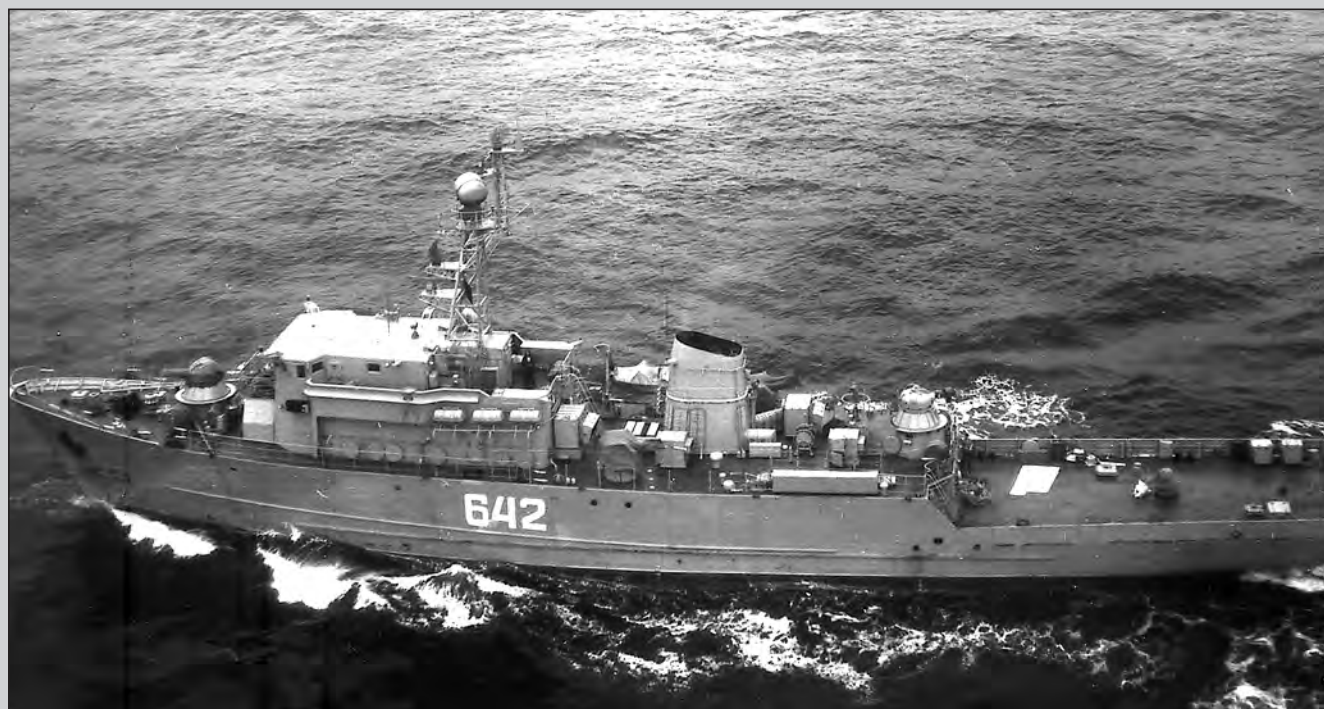
Okręt hydrograficzny „642” typu Natya . Zwraca uwagę rufowy pokład roboczy pozbawiony urządzeń trałowych.
