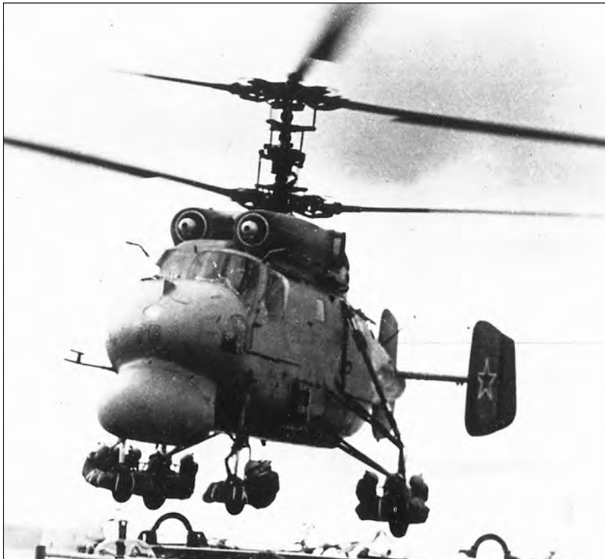
Startujący Ka-25PL z pływakami na kołach.
