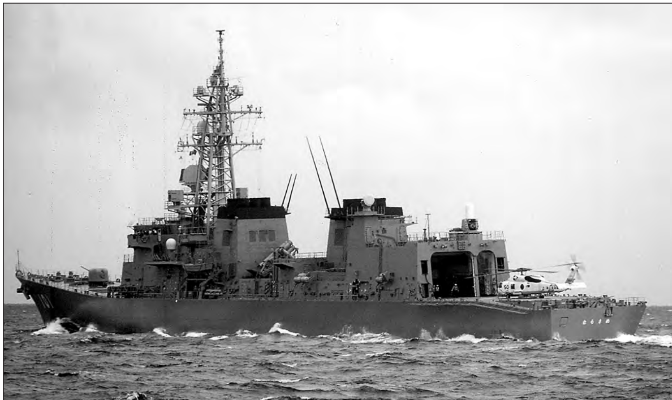
Murasame (DD 101) w ujęciu od rufy. Widoczna budowa hangaru i śmigłowiec pokładowy SH-60J na lądowisku.
