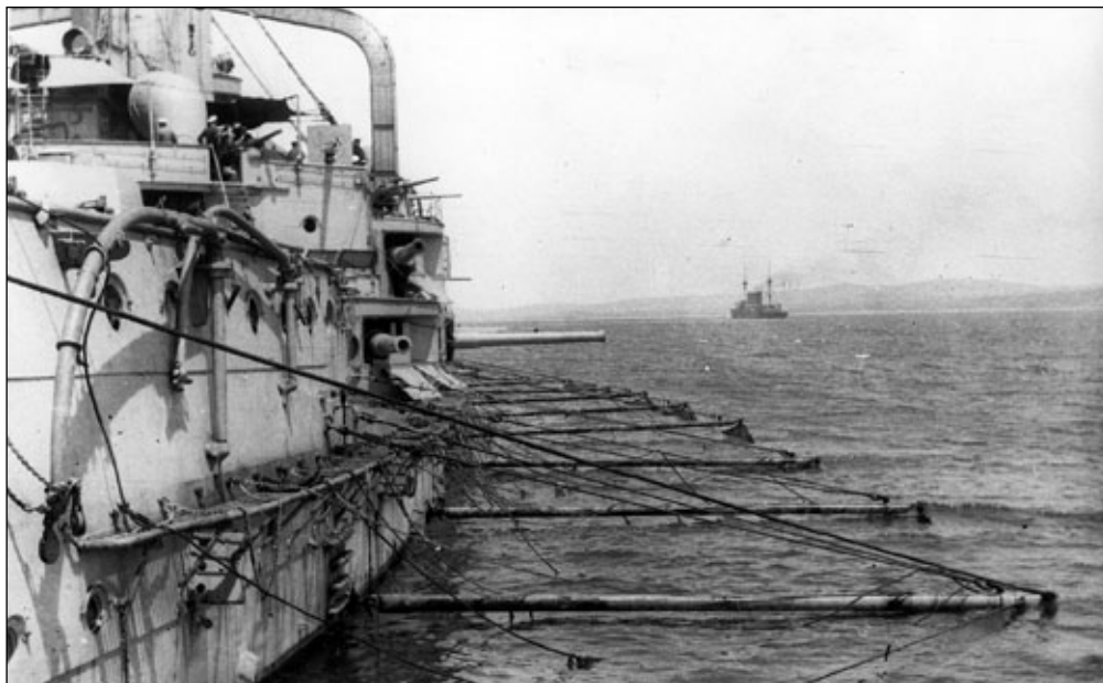
Unikalna fotografia prezentująca postawienie sieci przeciwtorpedowych na wytykach burtowych. Widoczne również działa kal. 190 mm w kazamatach. Fot. Württembergische Landesbibliothek
