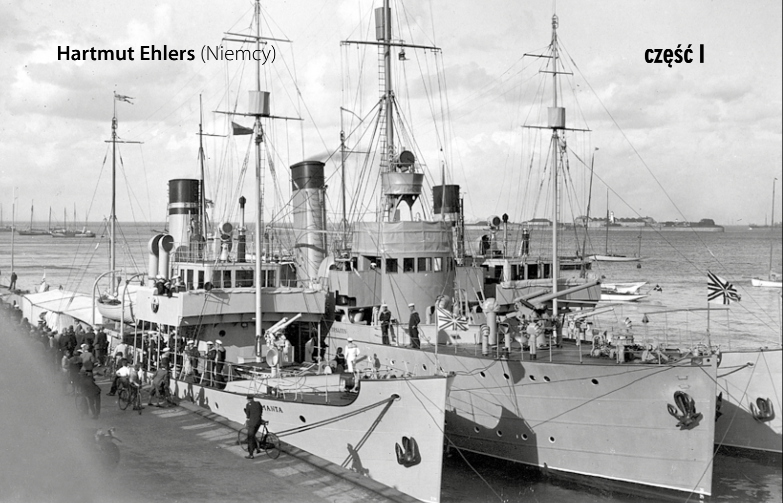
Kanonierka Virsaitis ze stojącymi u jej burty trawłowcami Imanta i Viesturs . Na fotografii widoczne różnice między obydwoma trawłowcami. Viesturs nosił jako wyróżnik dwa białe pasy na kominie, Imanta miała pojedynczy biały pas. Ponadto, różnej wysokości były nawiewniki obydwu okrętów, te na Viesturs były wyższe. Fot. zbiory Dmitry Dmitryev
