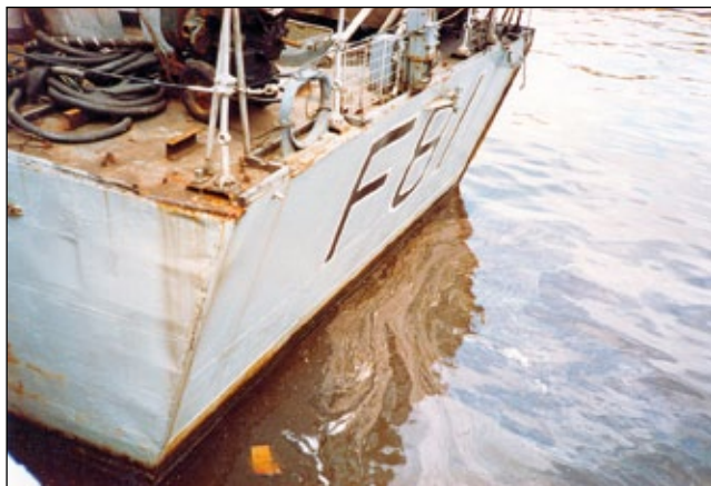
Stopień zaawansowania korozji kadłuba Doriny (z lewej) i Otopo .
