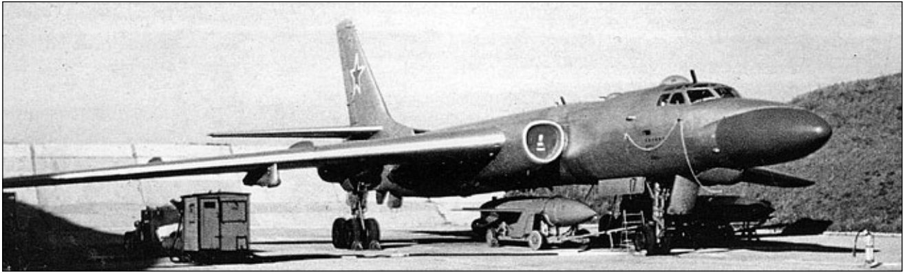
Podwieszanie pocisku K-10S pod kadłub Tu-16K-10-26. Samolot w obwałowaniu.
