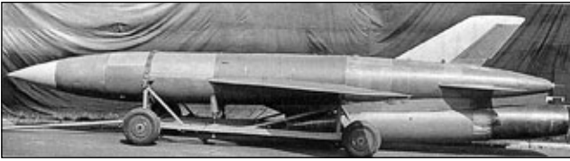
Pocisk doświadczalny K-10 na wózku transportowym. Na uwagę zasługuje wzór malowania, charakterystyczny w kontrastowe prostokąty ułatwiające pomiary optyczne. Fot. „M-Hobby”
