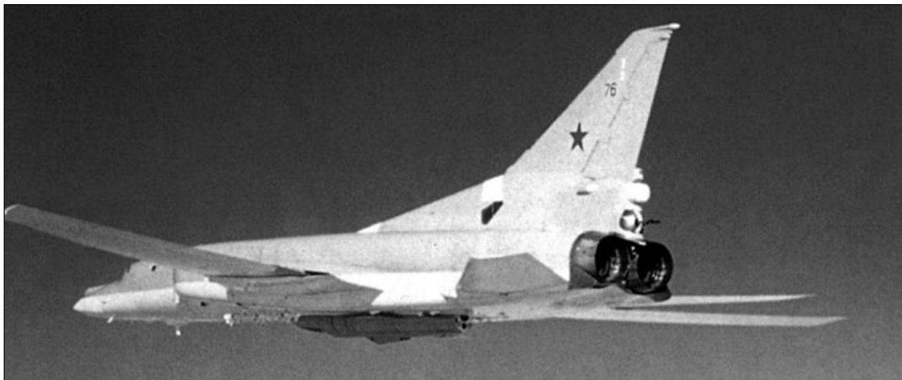
Jedna z pierwszych fotografii kompleksu Tu-22M2 wykonana przez lotnictwo szwedzkie. Dobrze widoczny pocisk raketowy H-22 pod kadłubem bombowca. Fot. „Marine Rundschau”
