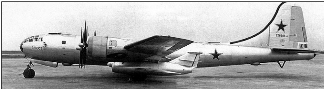
Kompleks przeciwokrętowy Tu-4KS „Kometa” z podwieszonymi pod skrzydłami dwoma pociskami skrzydlatymi KS-1.
