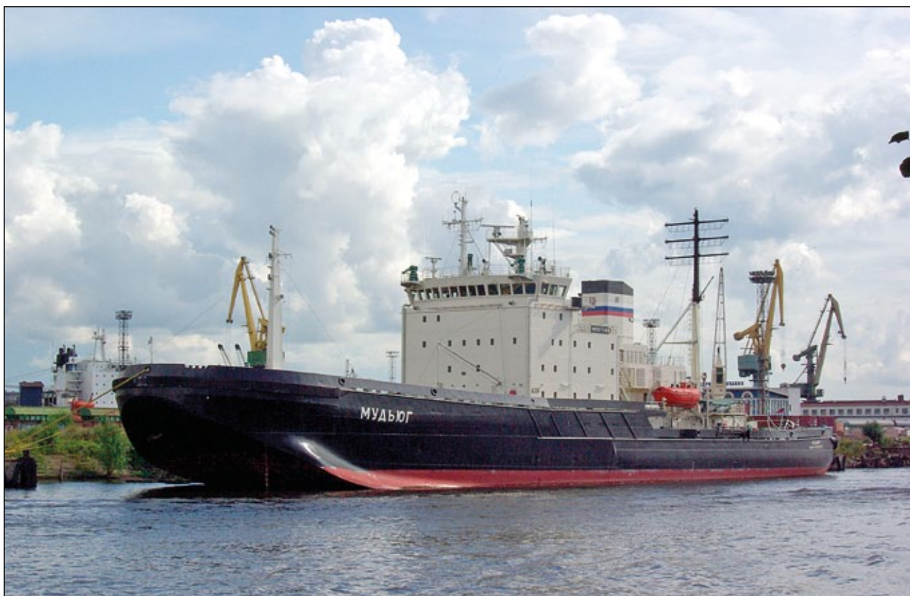
Mudyug po przebudowie z nowym dziobem, który okazał się również niezbyt efektywny.
