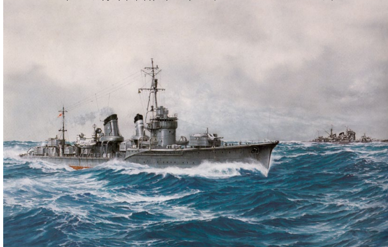
Niszczyciel Ikazuchi – jednostka typu „Akatsuki”, kontynuacji słynnych niszczycieli typu „Fubuki”. Jego główne uzbrojenie artyleryjskie kalibru 127 mm rozmieszczono w 3 dwulufowych wieżach, ale jego największą siłą były 3 trzyrurowe wyrzutnie torpedowe kalibru 610 mm.
