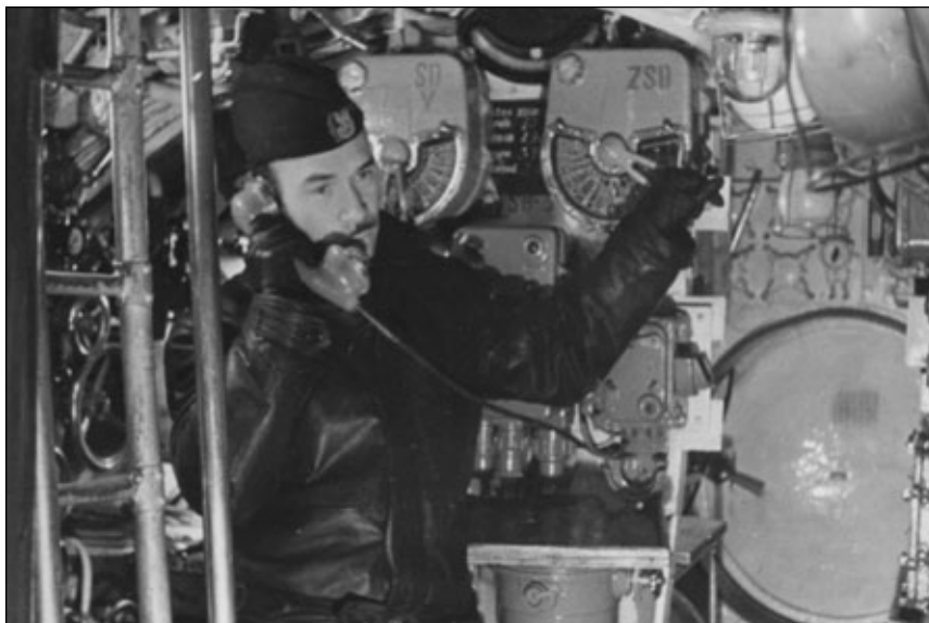
Centrala maszynowa na Krakowia ku. Na pierwszym planie telegrafy maszynowe silników napędowych spalinowych. Fot. Zbigniew Łukaszewicz
