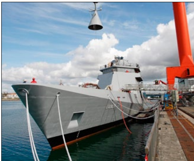
Korweta L'Adroit w czasie montażu masztu.
