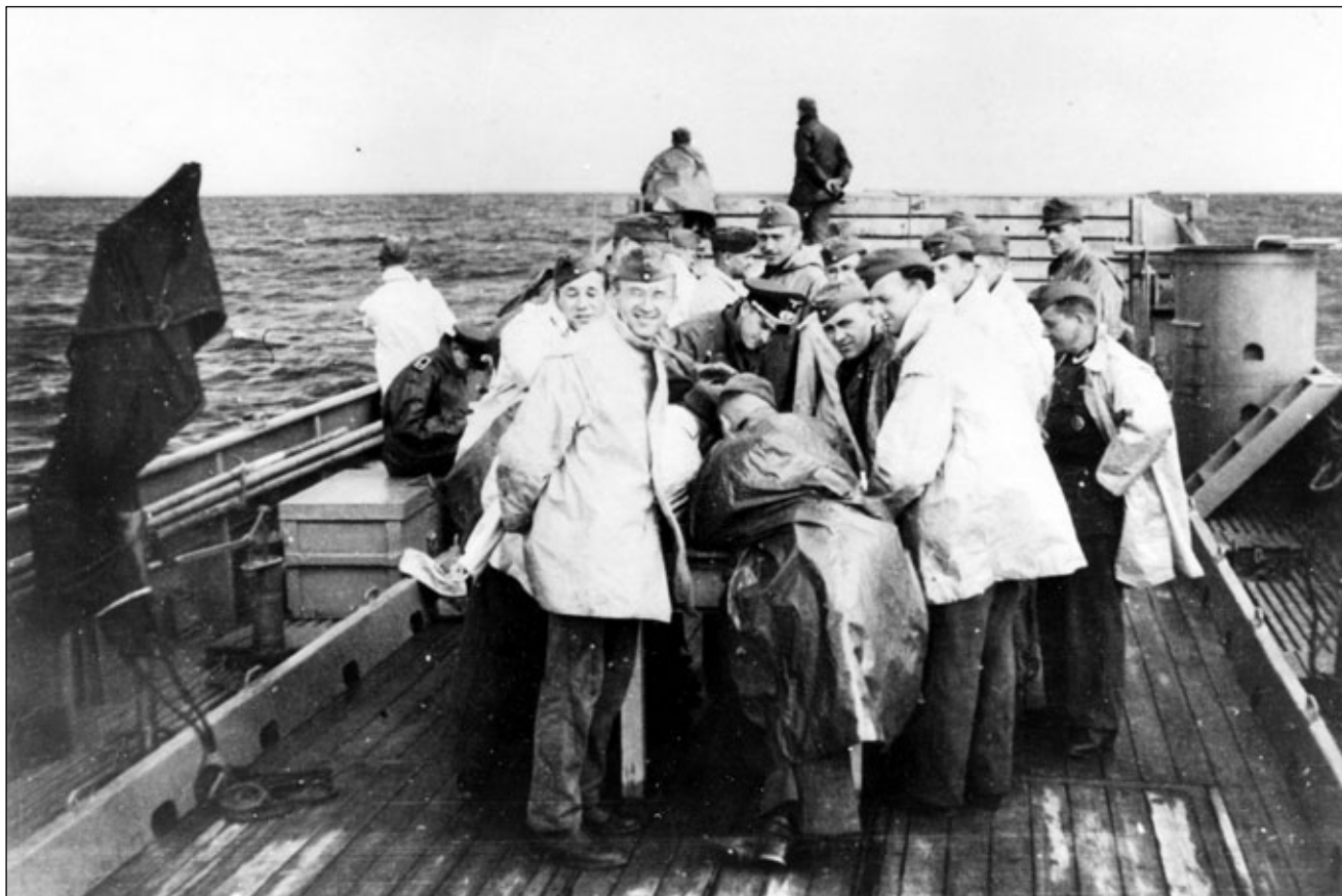
Scenka rodzajowa (gra w kości lub karty?). Dobrze widoczne elementy konstrukcji pokładu; drewniana podłoga z prowadnicami najazdowymi oraz na sterburcie podstawa działka plot.1 x I – kal. 20 mm L/65 typu C/38 (stalowy walec). Fot. zbiory Randolph Kugler via Reinhard Kramer
