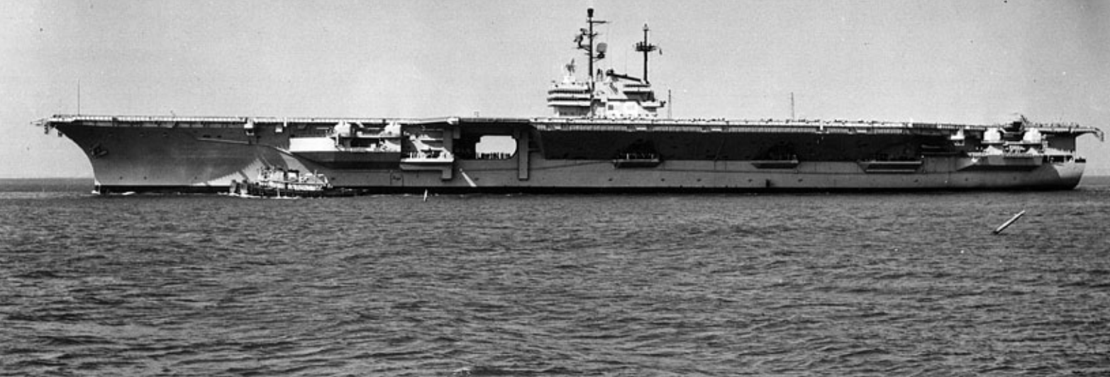
Forrestal w burtowym ujęciu na innej z fotografii wykonanych 29 września 1955 roku. Widoczne otwory umożliwiające przemieszczanie samolotów pomiędzy przednią częścią hangaru a obsługującymi ją dziobowymi podnośnikami lotniczymi. Fot. zbiory Artur D. Baker III
