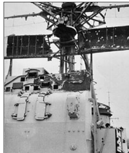
Pierwszy chiński pocisk trafił London w wieżę „B” lecz nie zdołał przebić jej pancerza (z lewej), jeden z kolejnych uszkodził dalmierz główny i antenę radiolokatora. (z prawej). Fot. zbiory Marcin Mikiel
