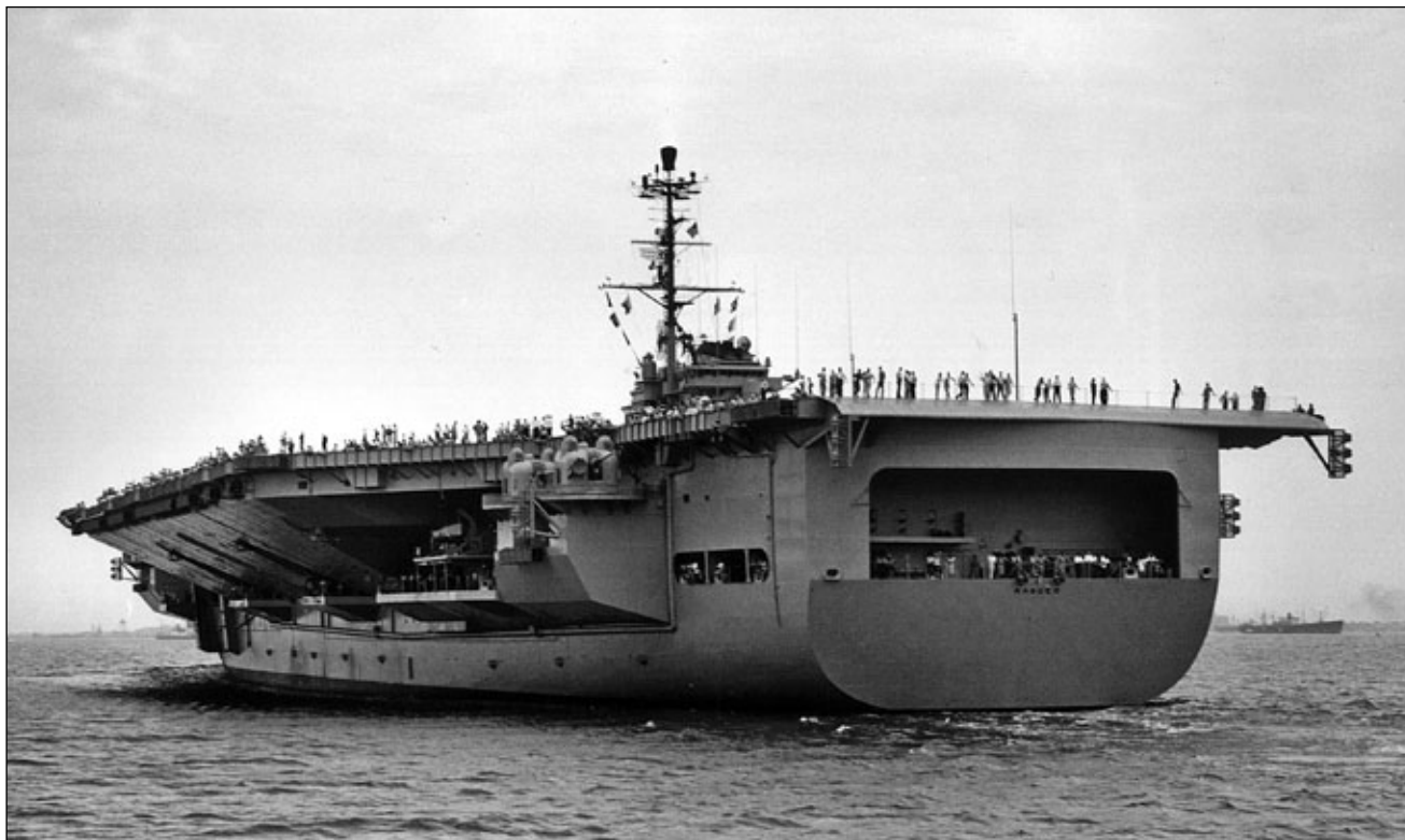
Fotografia Ranger wykonana w dniu 9 lipca 1957 roku w Hampton Roads. Doskonale widoczny potężny sponson podpierający lewoburtową krawędź pokładu skośnego oraz odmienny, zamknięty kształt rufy będący wyróżnikiem drugiej pary lotniskowców typu Forrestal . Fot. zbiory Artur D. Baker III
