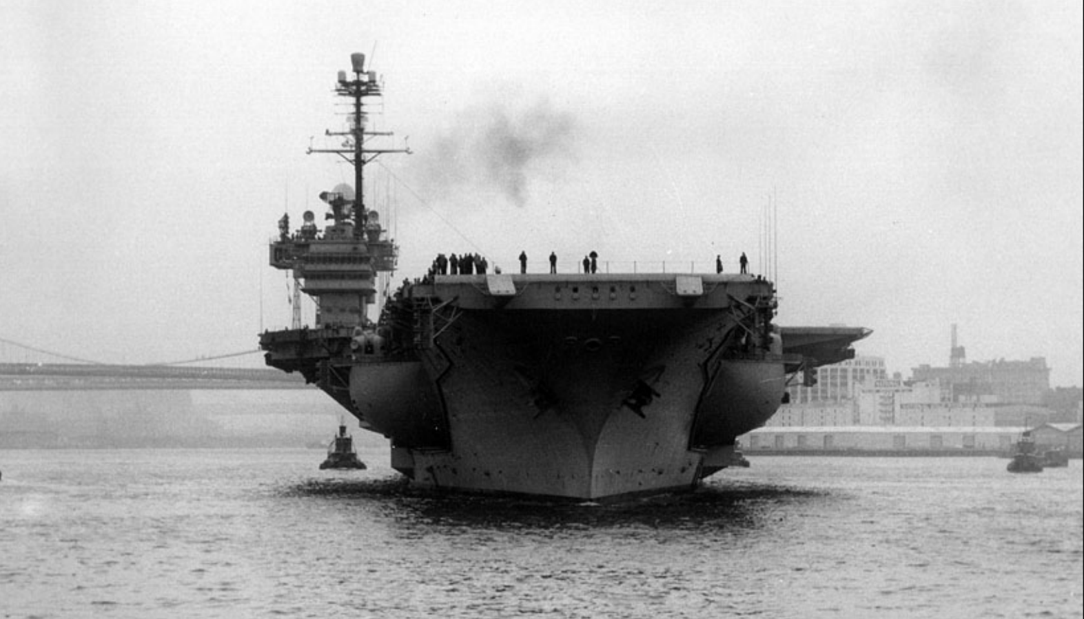
Lotniskowce typu Forrestal otrzymały zamknięte dzioby o wysokiej wolnej burcie, których kształt zapewniał suchą żeglugę praktycznie w każdych warunkach pogodowych. Tutaj Independence na fotografii wykonanej w New York Naval Shipyard w dniu 2 marca 1959 roku. Zaokrąglone kształty sponsonów przednich stanowisk artylerii uniwersalnej były doskonale widocznym wyróżnikiem tego okrętu. Fot. zbiory Artur D. Baker III
