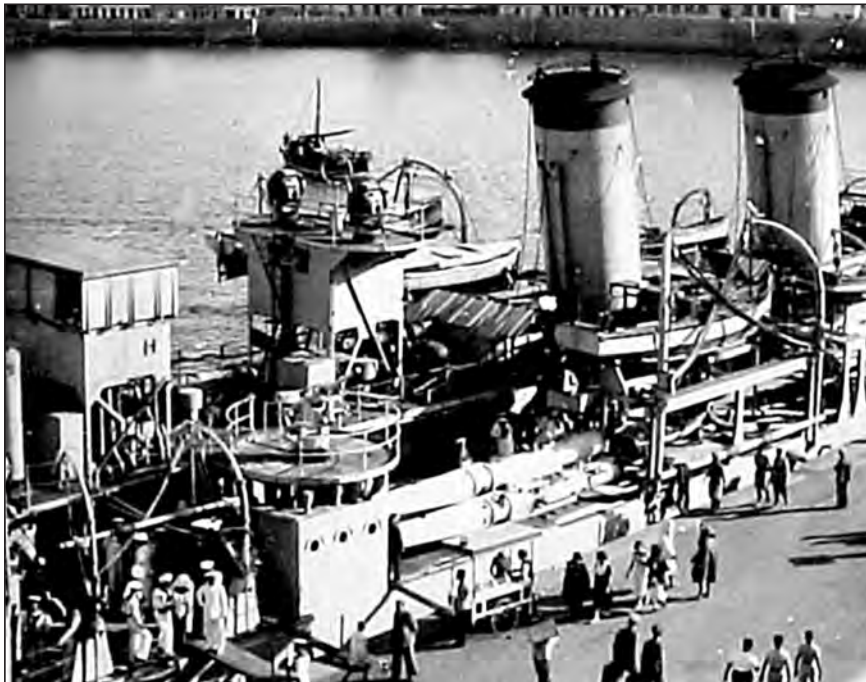
Śródkorcie krążownika z dobrze widoczną wyrzutnią torped.
