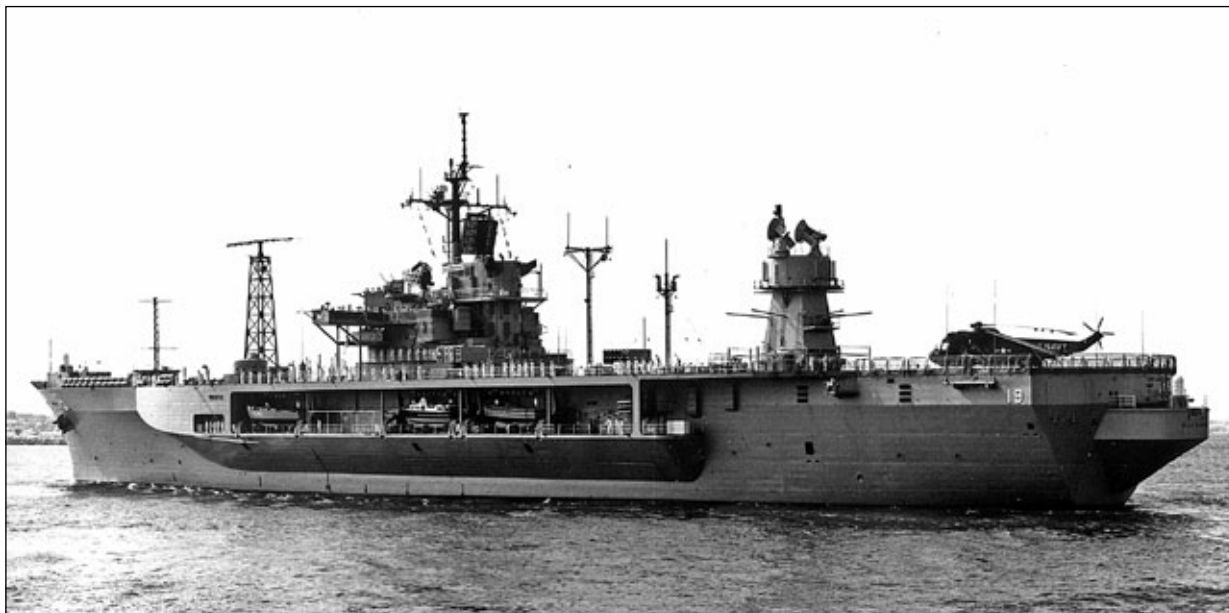
Blue Ridge (LCC-19) w październiku 1986 roku. Uzbrojenie przeciwlotnicze okrętu zostało wzmocnione przez dwa artyleryjskie zestawy obrony bezpośredniej Mk 15 „Phalanx”. Oprócz urządzeń radiokomunikacji dalekiego zasięgu („Yagi”) okręt posiadał systemy łączności satelitarnej zamontowane na wieżowym maszcie rufowym. Wśród wyposażenia radiolokacyjnego m.in. radar trójwspółrzędny SPS-48C, którego duża antena widoczna jest na nadbudówce.
