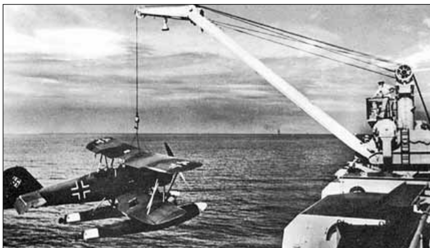
Na krótko przed wybuchem działań wojennych dotychczasowy dźwig pokładowy pancernika zastąpiono konstrukcją firmy DEMAG. Tutaj widoczny z He 60 na haku.
