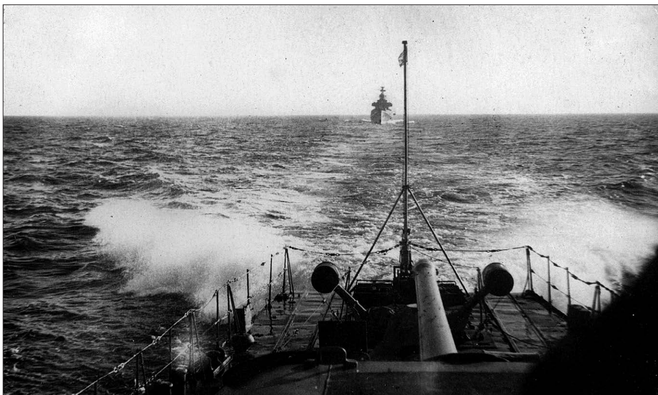
Widok na rufę niszczyciela Stawnyj . Dobrze widoczne miotacze bomb głębinowych BMB-1. Fotografia powojenna, gdyż za rufą widoczny niszczyciel proj. 56. Fot. A. Caplin
