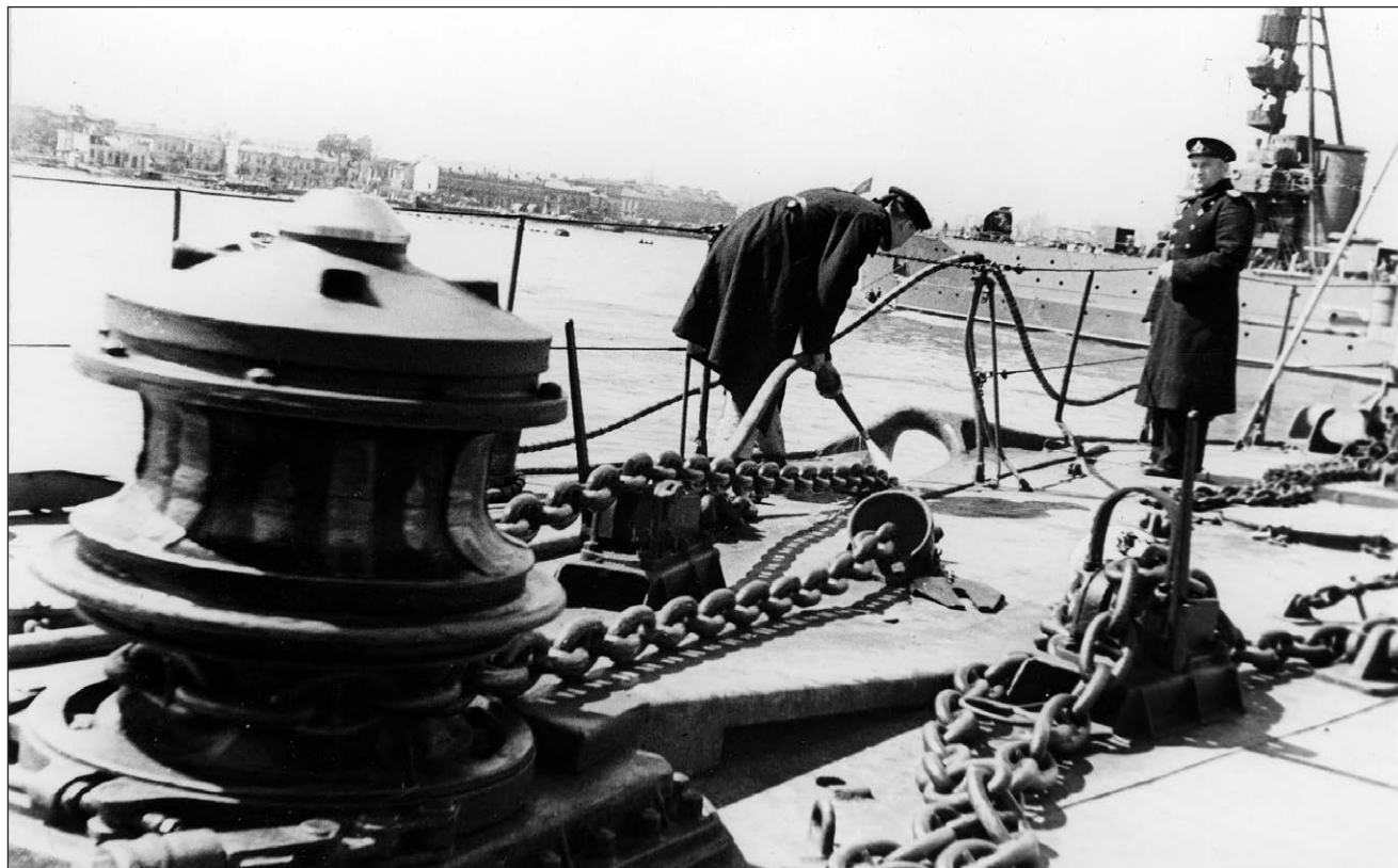
Wciągarka kotwiczna niszczyciela Soobrazitielnyj . Fotografia wykonana w Poti w kwietniu 1943 roku.
