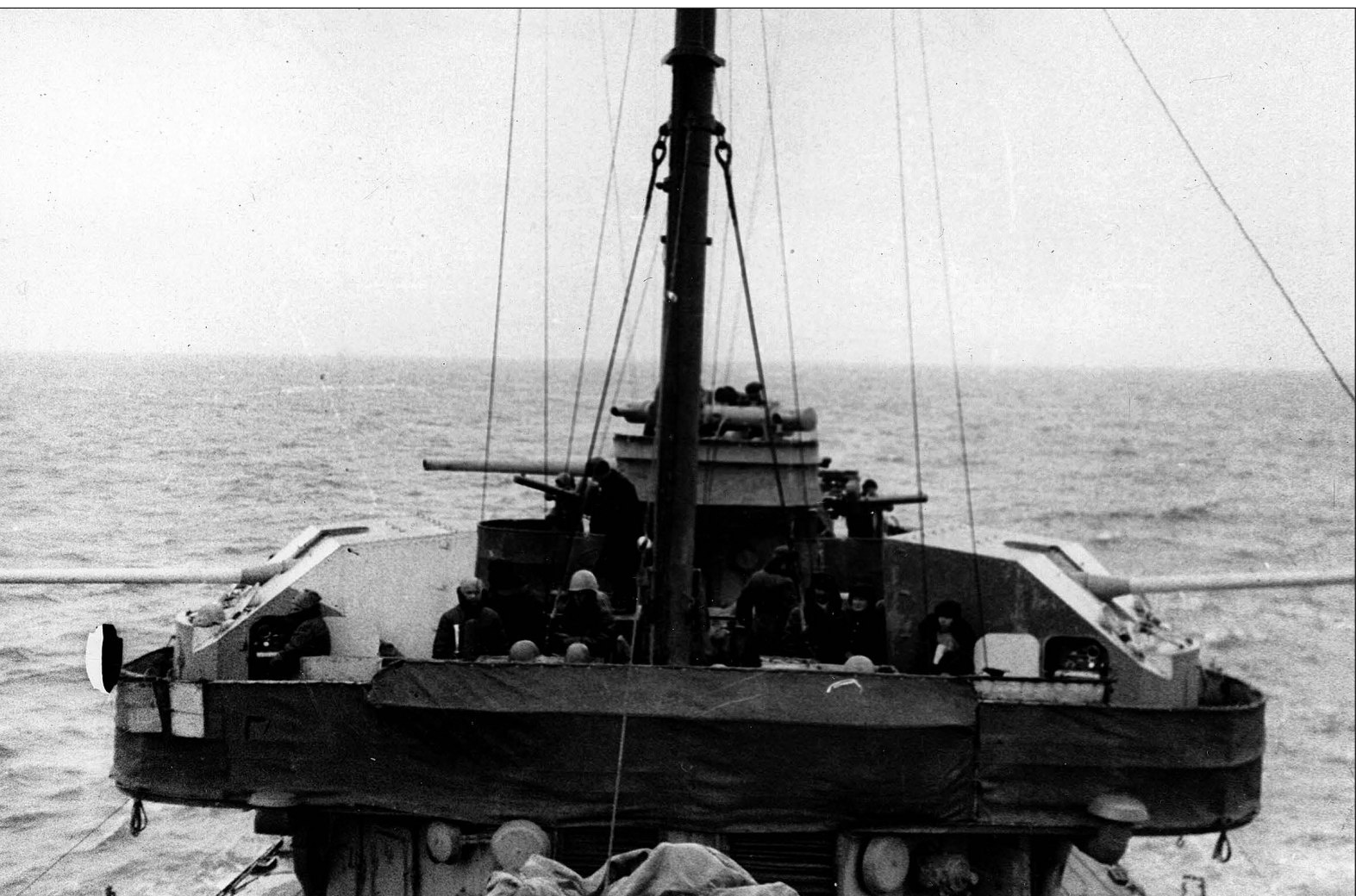
Działa kal. 76 mm 34-K na niszczycielu Sokrushielnyj , 1942 roku. Na nadbudówce rufowej widoczne sprzężone podwójnie wkm-y kal. 12,7 mm Colt-Browning.
