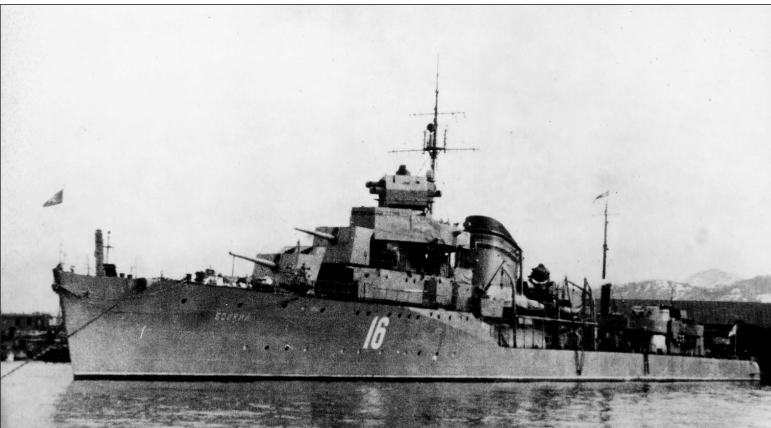
Bojkij w latach 1943-1944. Zwraca uwagę niezwykle umieszczenie uzupełniającego automatycznego działka kal. 37 mm 70-K – na pokładzie dziobówki na lewej burcie, przed dziobowym działem kal. 130 mm. Fot. zbiory Siergieja Bałakina
