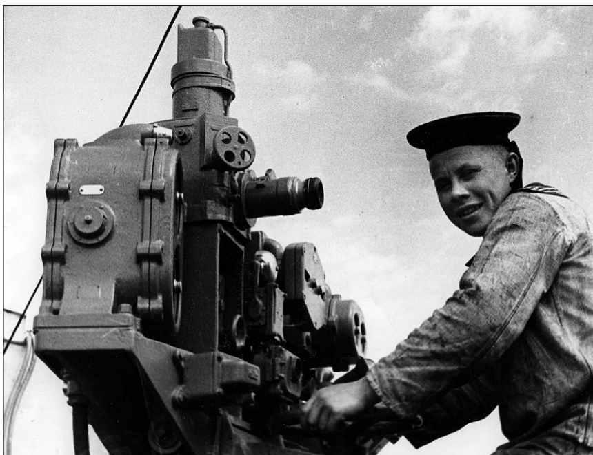
Stanowisko kierowania ogniem wyrzutni torpedowej 59-Ju niszczyciela Razumnyj . Za nim celowniczy 2 wyrzutni torpedowej Tutulmin . Fot. zbiory Siergieja Bałakina
