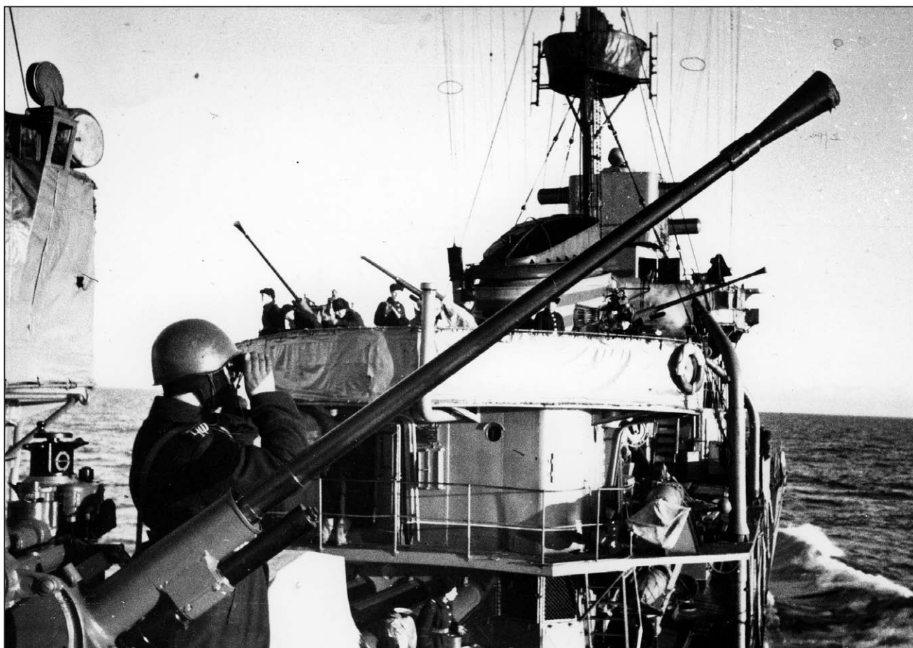
Soobrazitelnyj na morzu, początek 1943 roku. Na górnej fotografii dobrze widoczne mieszane uzbrojenie przeciwlotnicze zainstalowane na platformie za pierwszym kominem: 2 automatyczne działa kal. 37 mm 70-K i 1 półautomatyczne działo kal. 45 mm 21-K. Fot. RGAKFD
