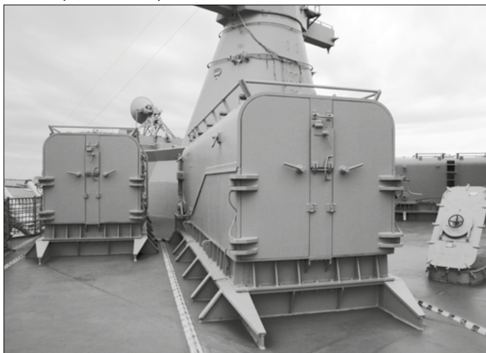
Kontenery z poczwórnymi wyrzutniami pocisków manewrujących BGM-109 „Tomahawk” pancernika Wisconsin w położeniu marszowym. Fot. Jarosław Palasek
