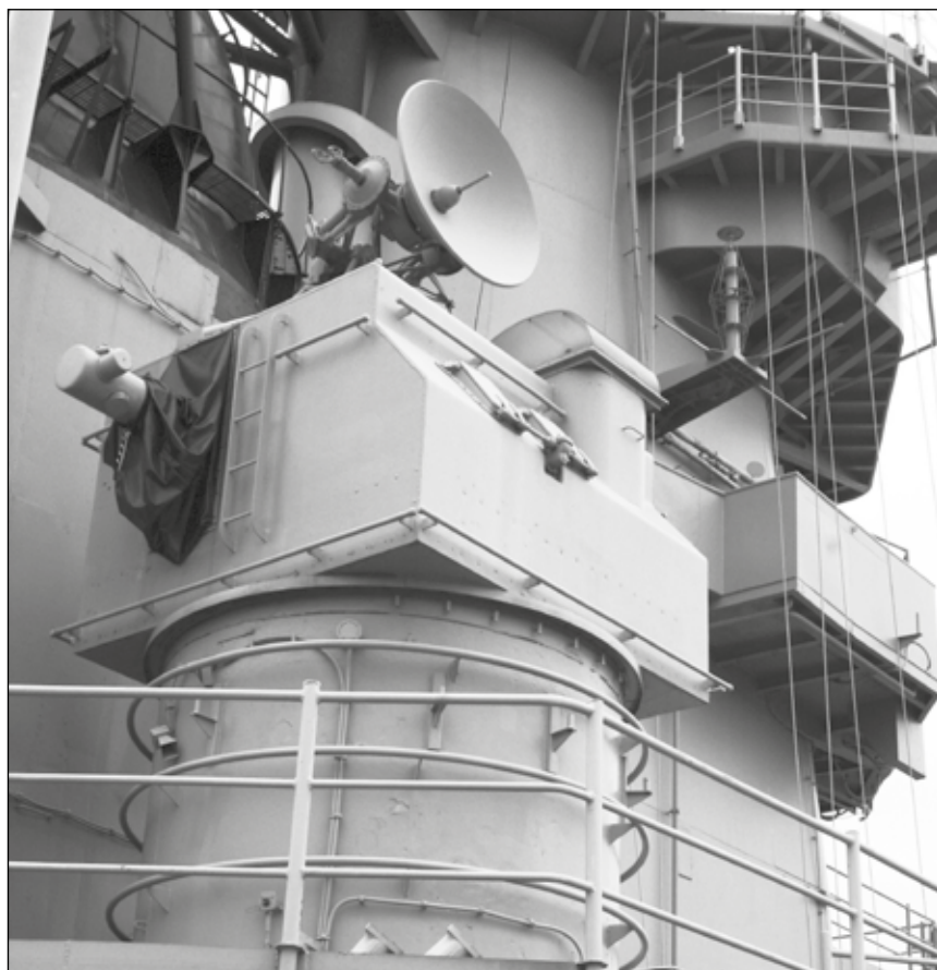
Usytuowany na prawej burcie nadbudówki pancernika Wisconsin dalecełownik Mk 37 kontroli ognia artylerii uniwersalnej z radiolokacyjną stacją Mk 25 wyposażoną w antenę kołową. Fot. Jarosław Palasek
