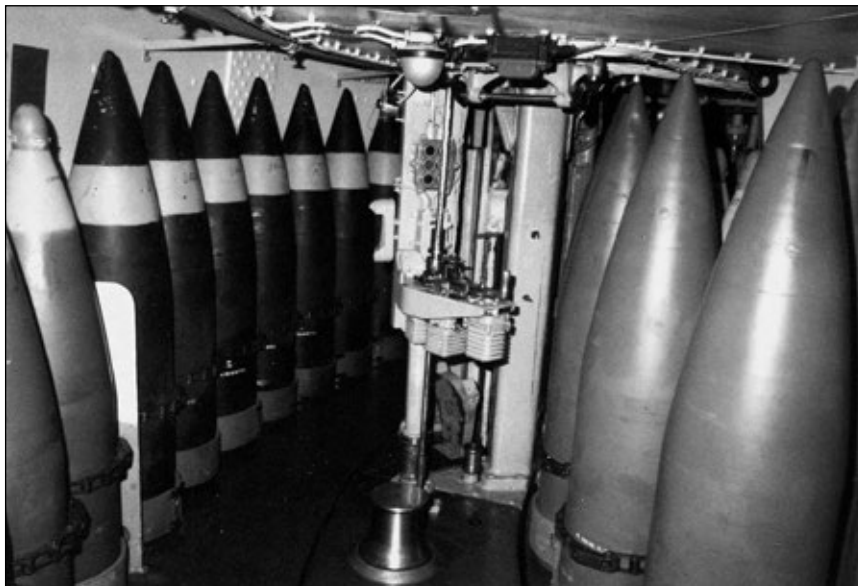
Pokład magazynowy pocisków jednej z wież artylerii głównej pancernika Iowa na fotografii wykonanej 6 stycznia 1987 roku. Z lewej pociski burzące Mk 13 oraz przeciwpancerne Mk 8, z prawej pociski ćwiczebne. Fot. U.S. Navy
