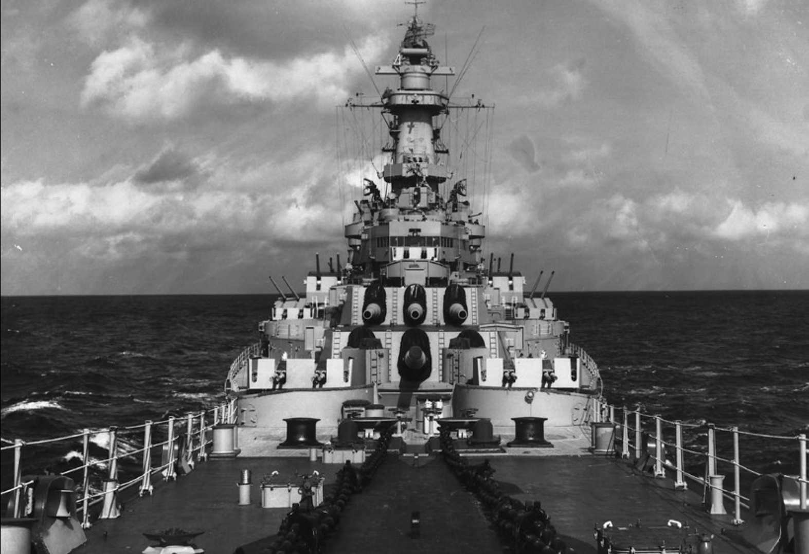
Widok na śródokręcie Wisconsin podczas jednego z rejsów poprzedzających skierowanie okrętu na Daleki Wschód. Wykonana 21 marca 1952 roku fotografia dobrze ilustruje rozmieszczenie artylerii w części dziobowej pancernika w okresie wojny koreańskiej. Fot. zbiory A. D. Bakera III
