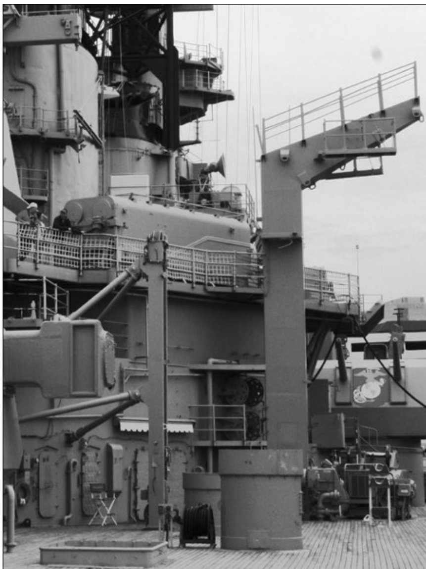
Podczas modernizacji pancerniki typu „Iowa” otrzymały system bunkrowania w morzu zgodny ze standardami RAT. Tutaj wchodzący w jego skład maszt kolumnowy ze stałym wysięgnikiem na Wisconsin . Fot. Jarosław Palasek
