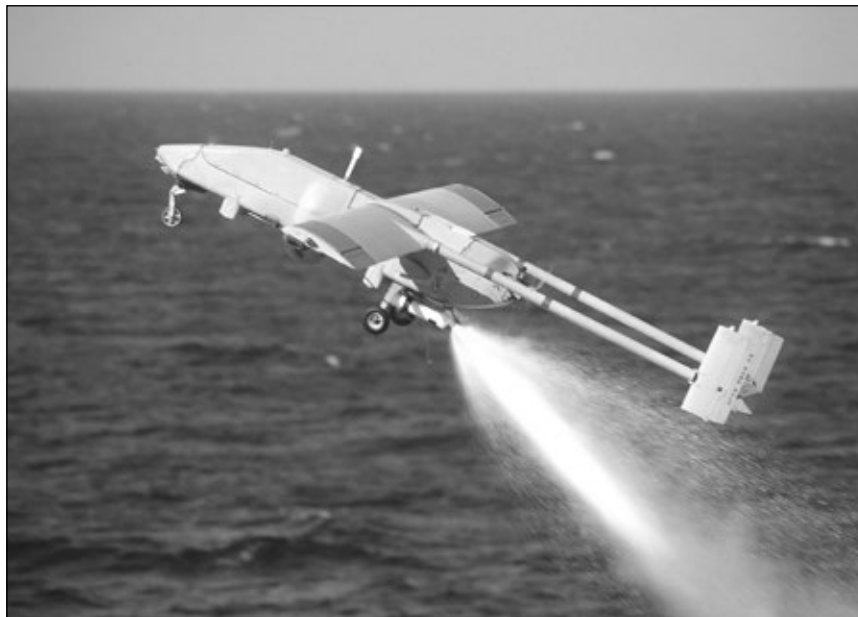
Wspomagany silnikiem raketowym start zdalnie kierowanego samolotu rozpoznawczego AAI/IAI RQ-2 „Pioneer” podczas prób systemu na pokładzie pancernika Iowa w dniu 1 listopada 1986 roku. Fot. U.S. Navy
