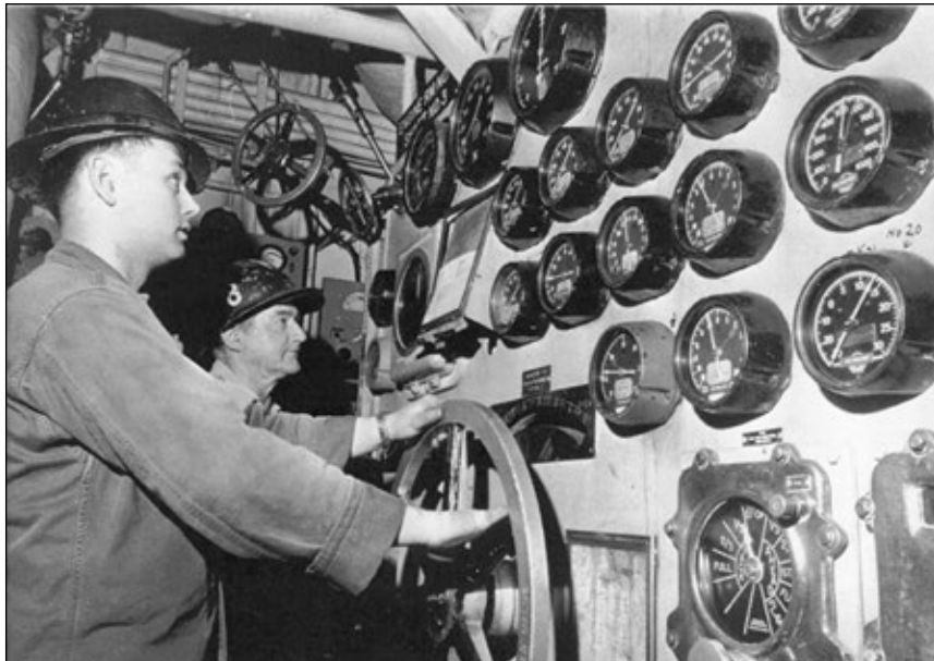
Cywilni mechanicy ze stoczni marynarki w Filadelfii w trakcie uruchamiania turbozespołu Nr 3 New Jersey podczas przywracania pancernika do służby w Wietnamie. Fot. U.S. Navy
