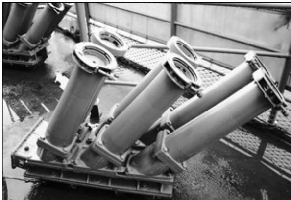
Jedna z wyrzutni celów pozornych Mk 36 SRBOC Mod.2 systemu walki radioelektronicznej SLQ-32 pancernika New Jersey . Fot. Jarosław Palasek
