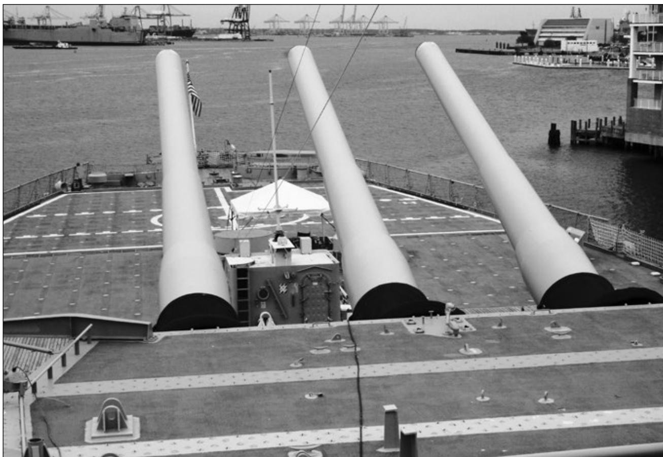
Wszystkie wieże artylerii głównej pancerników typu „Iowa” wyposażono w radiolokacyjne mierniki prędkości wylotowej pocisków typu DR-810, których anteny usytuowano nad środkowymi armatami. Tutaj widok armat rufowej wieży Wisconsin. Fot. Jarosław Palasek
