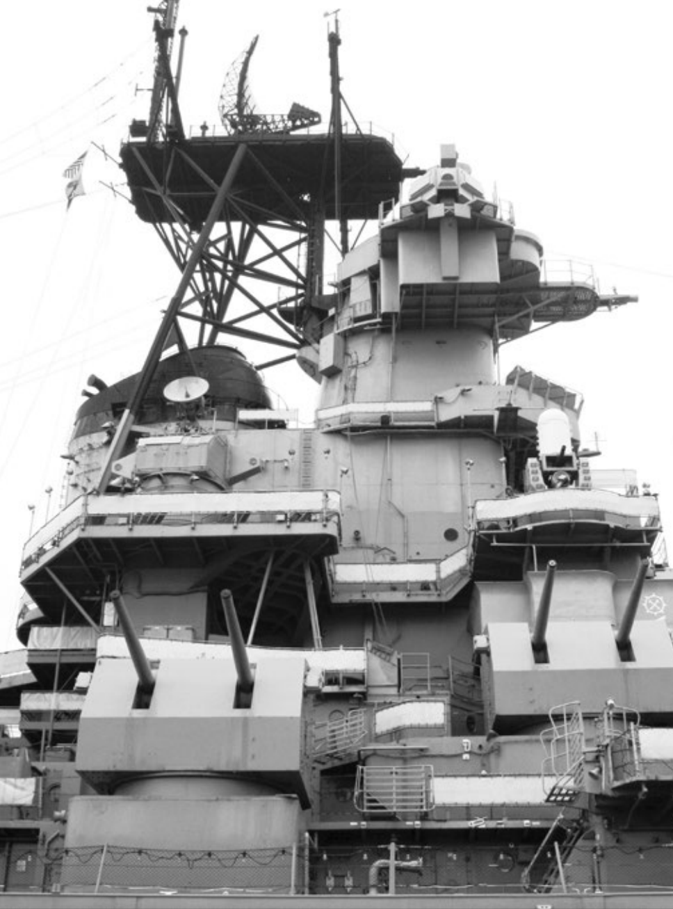
Przednia wieża kontroli ognia pancernika New Jersey z antenami systemu walki radioelektronicznej SLQ-32. Na platformie masztu widoczna antena stacji radiolokacyjnej SPS-49. Fot. Jarosław Palasek
