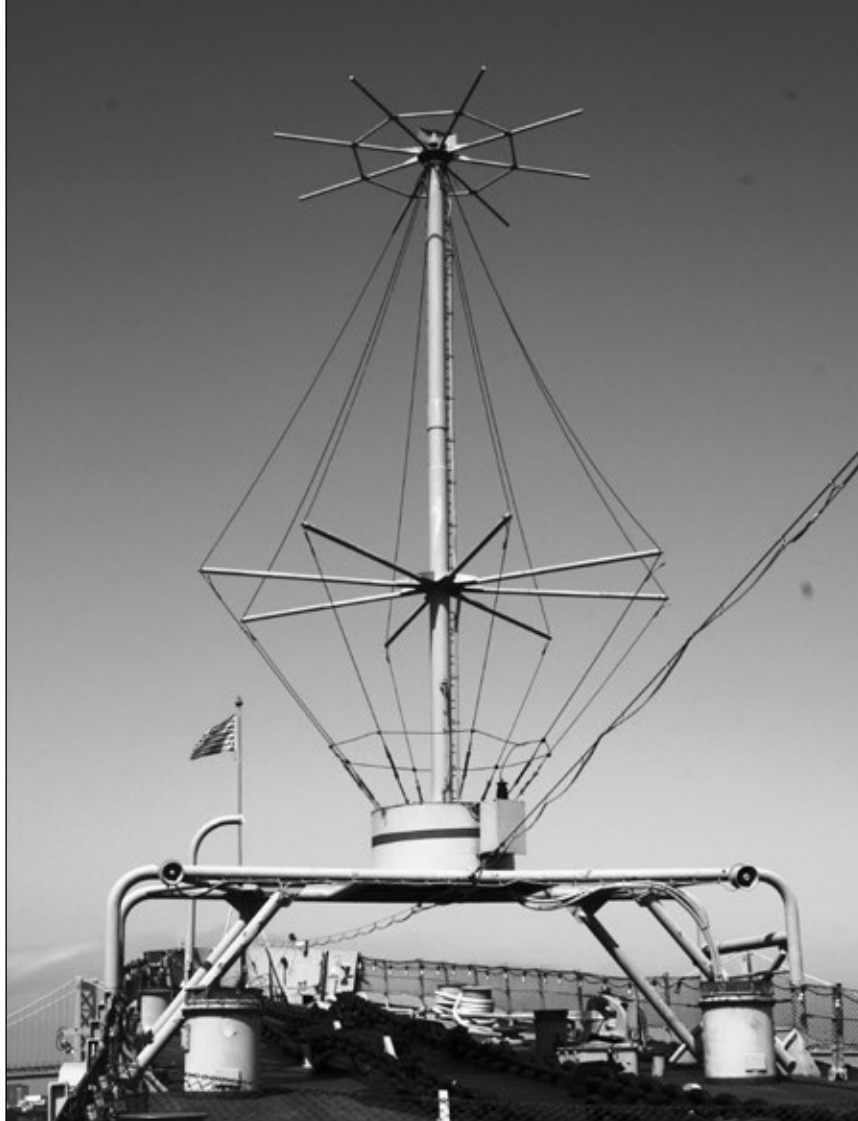
Usytuowana na dziobie New Jersey zamontowana na specjalnej konstrukcji wsporczej charakterystyczna antena systemu wymiany danych taktycznych (NTDS) Link 14.
