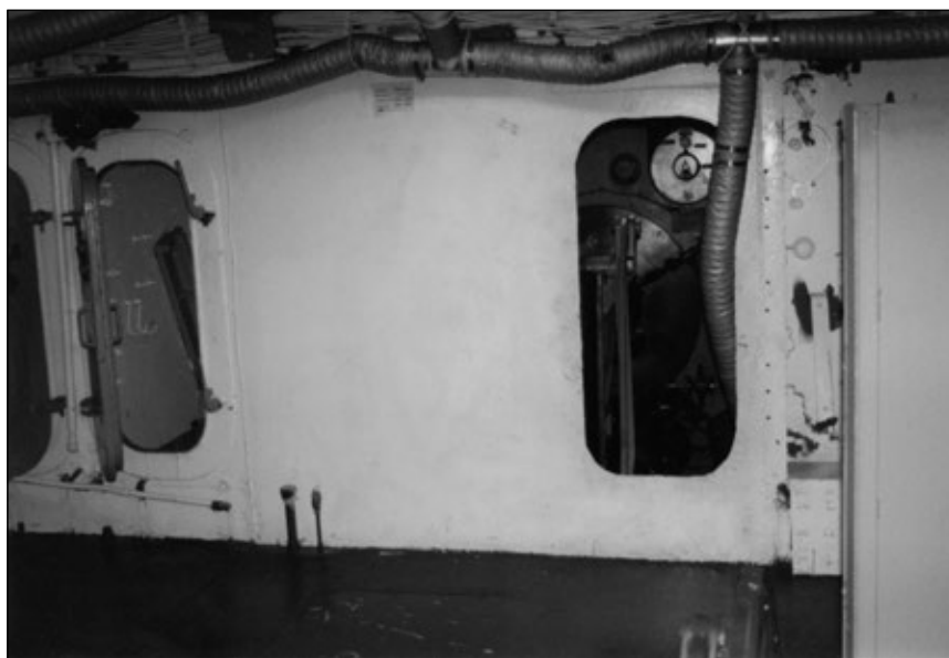
Wykonana 30 sierpnia 1995 roku fotografia grodzi oddzielającej przedział dowodzenia od przedziałów armat uszkodzonej w wyniku eksplozji wieży artylerii głównej Nr 2 Iowy . Fot. zbiory Hartmuta Ehlersa
