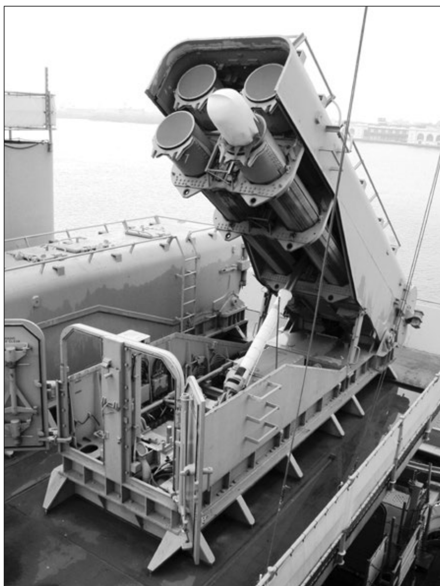
Jedna z poczwórnych wyrzutni ABL-141 pancernika New Jersey w położeniu startowym z atrapą odpalanego pocisku manewrującego BGM-109 „Tomahawk”.
