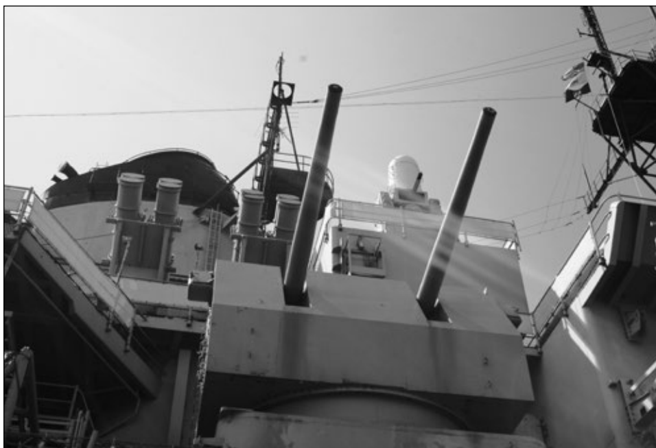
Widok na dwie poczwórne wyrzutnie pocisków RGM-84 „Harpoon” usytuowane ponad wieżą artylerii kalibru 127 mm pancernika New Jersey . Wyżej artyleryjski zestaw obrony strefy bliskiej Mk 15 „Phalanx”. Fot. Jarosław Palasek
