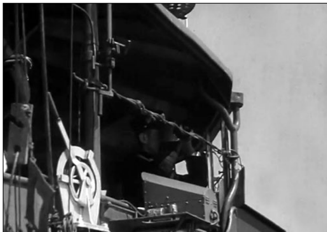
Dwie klatki z kroniki filmowej, wykonane na pokładzie torpedowca typu „Chidori” w czasie operacji w Hankou (1938 r.). Z lewej: widok na prawe skrzydło pomostu nawigacyjnego, z prawej: widoczny dalmierz i maszt główny. Fot. Youtube
