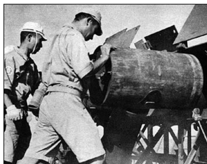
Miotacz Typ 94 (z lewej, fotografia powojenna) i jego załadunek za pomocą stelaża szybkiego załadunku. Fot. Axis History Forum
