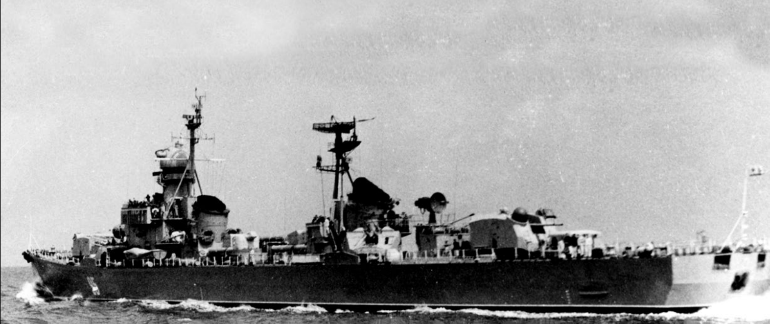
Nieustraszimyj w 1958 roku po przebrojeniu w czterolufowe działa SM-20-ZIF kal. 45 mm. Jedno z nich widoczne jest na wysokości rufowego komina. Fot. NH&HC
