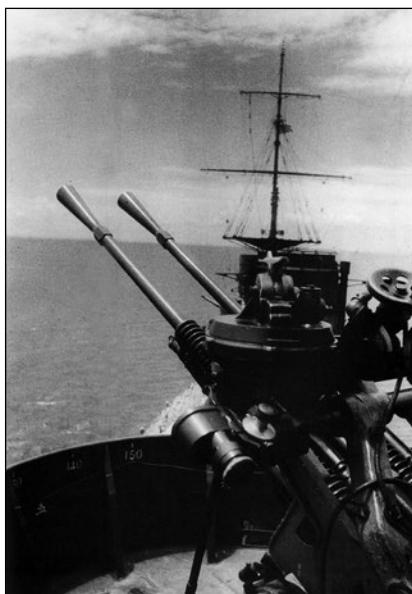
25 mm podwójnie sprzężone działo na burcie jednego z japońskich pancerników. Na pierwszym planie widoczny celownik.
