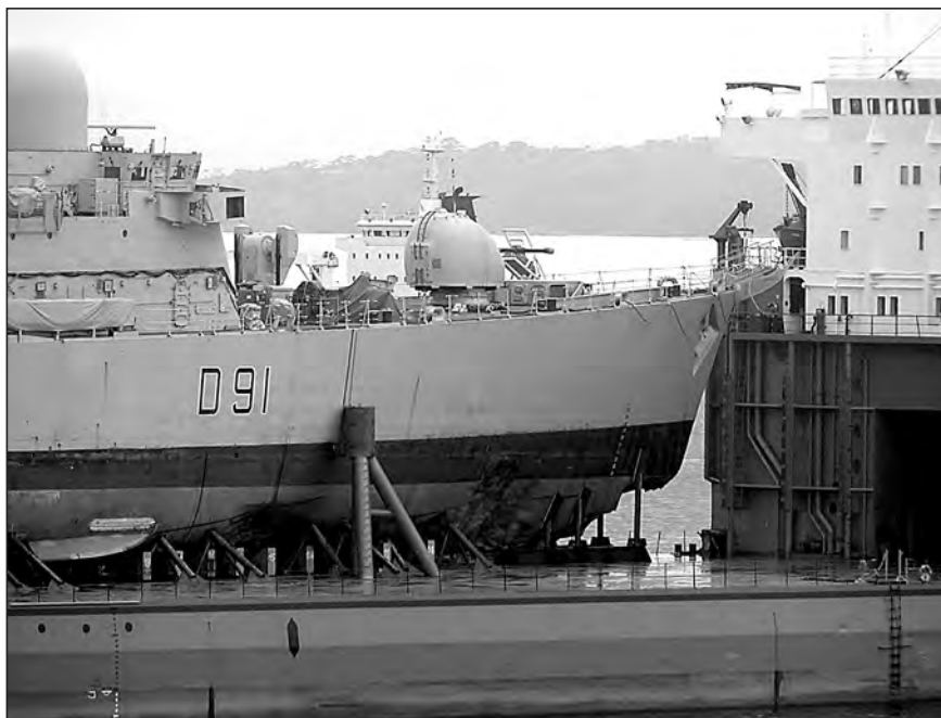
Inne ujęcie Nottingham na ciężarowcu. Fotografia dobrze ukazuje rozmiar uszkodzeń podwodnej części kadłuba aż po wyrzutnie rakiet „Sea Dart”. fot. Dariusz Adamczyk
